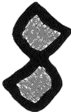
Figura 2.8 - Ligações formadas devido às tensões superficiais do líquido
