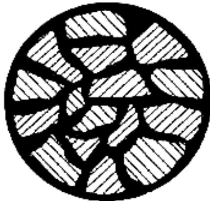
Figura 2.13 – Estágio final da formação da pelota
