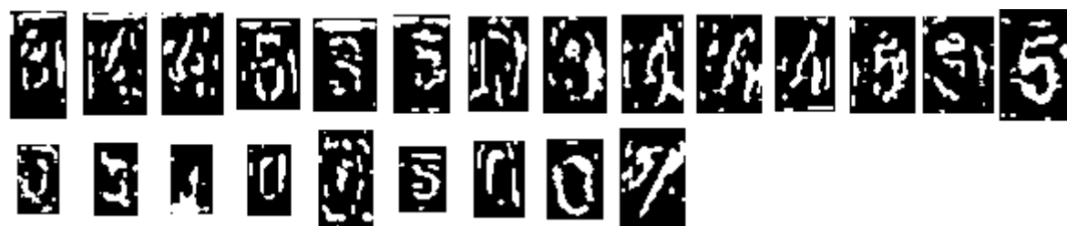
Figura 46: Imagens da Figura 42 após aplicação do filtro de médias de 3 \times 3 pixels.
