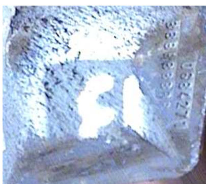
Figura 56: Tarugo identificado corretamente mesmo com a presença de pintura. A tinta não contamina a margem inteira.
