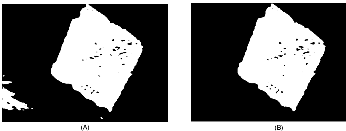
Figura 61: Em (A): Imagem B da Figura 60 depois da aplicação do filtro de mediana. Em (B): Escolha do objeto oitto conectado com maior área.
