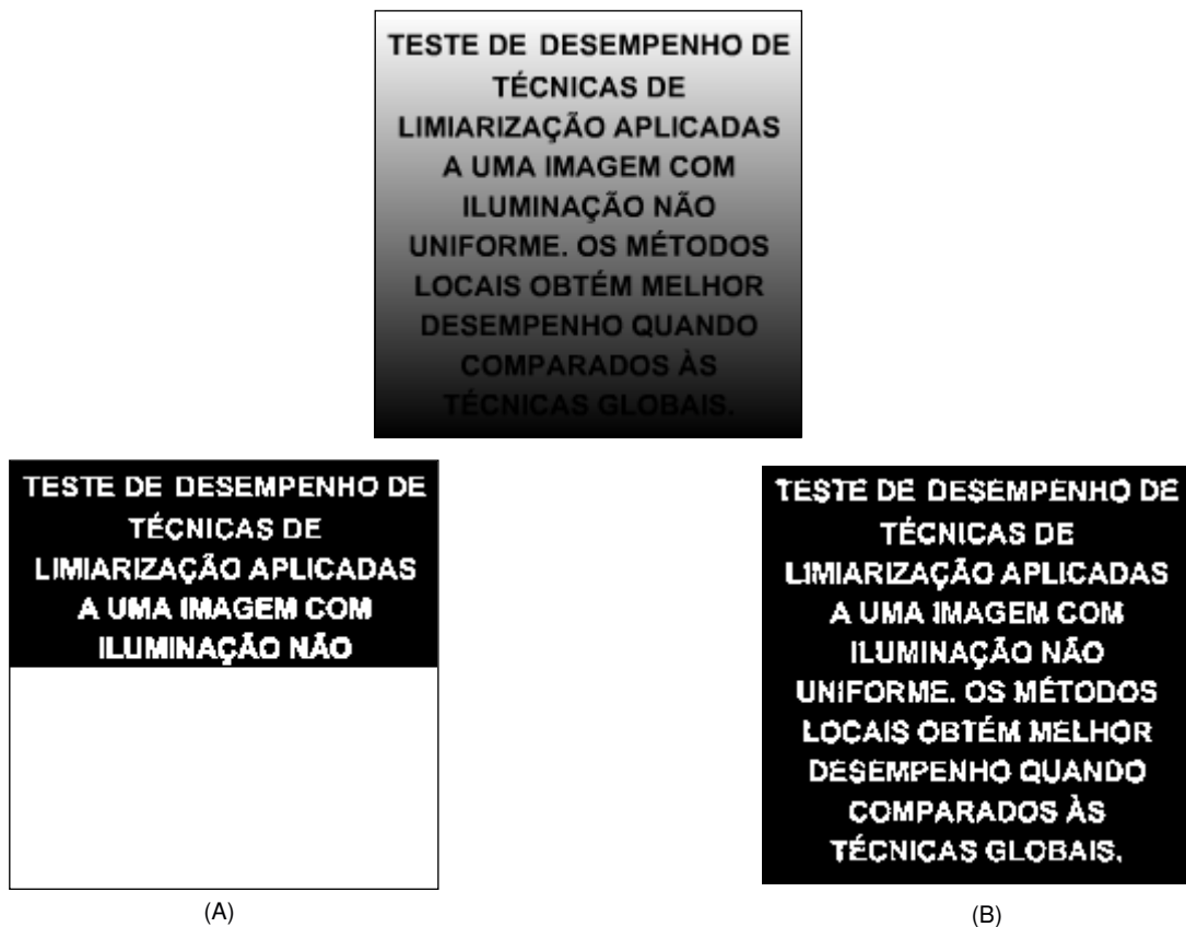
Figura 11: Exemplo de uma imagem com iluminação não uniforme. Em (A): Resultado da aplicação do método global de Otsu [41]. Em (B): Resultado da aplicação do método local de Niblack [38].
