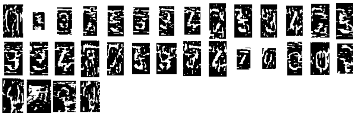
Figura 41: Imagens do grupo 3 limiarizadas após equalização de histograma. Imagens limiarizadas com o limiar \mu(i, j) - 0,9 * \sigma(i, j) .
