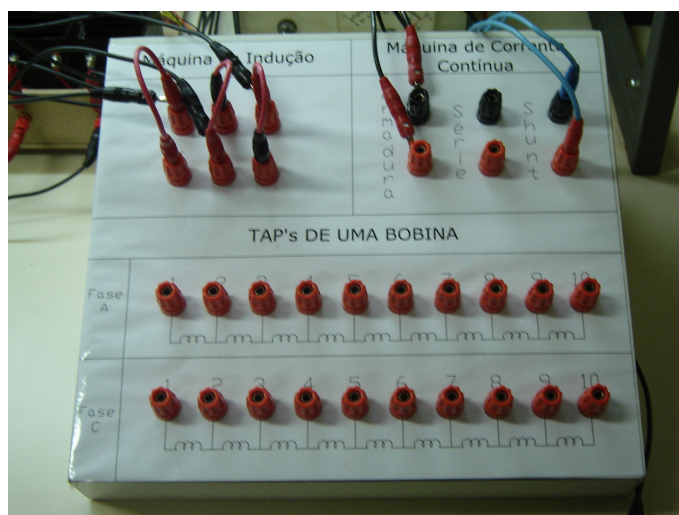
Figura 7.3: Placa de bornes que facilita o fechamento e alimentação do motor de indução, alimentação do campo e aplicação de carga na máquina de corrente de contínua e curto-circuito entre espiras.
