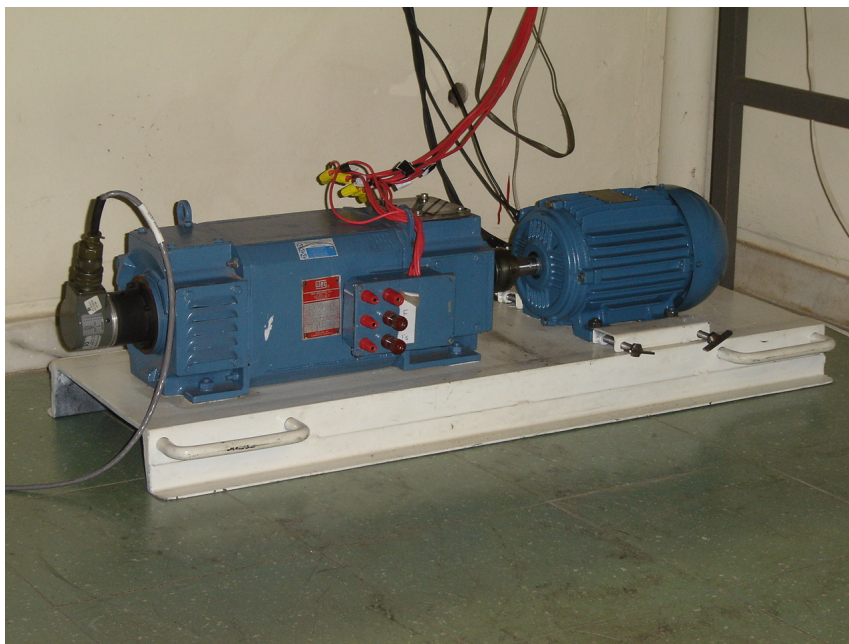
Figura 7.2: Foto parcial da bancada, mostrando a base de fixação do motor e o acoplamento flexível entre as duas máquinas elétricas.
