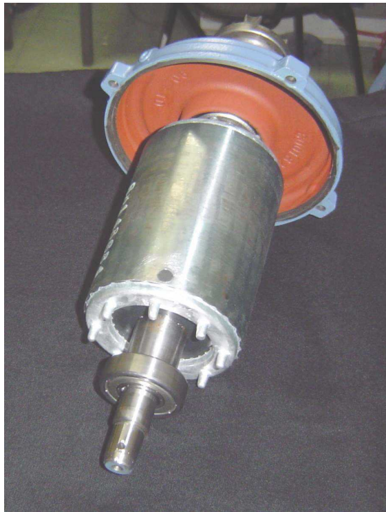
Figura 7.20: Rotor com a barra rompida.
