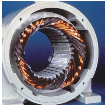
Figura C.2: Falta de fase
