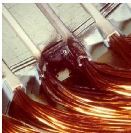
Figura C.8: Bobina em curto para massa na saída da ranhura
