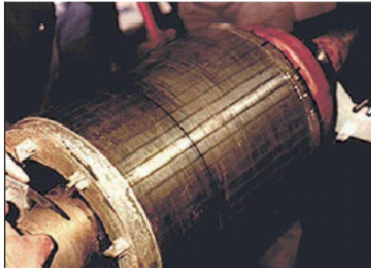
Figura 2.9: Rotor de um motor de 150 HP , com seis barras quebradas. Entretanto não é possível a visualização das barras quebradas. Figura extraída do artigo do Thomson e Fenger (2001).
