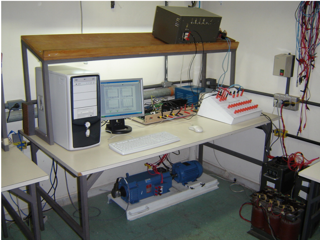
Figura 7.1: Foto da bancada de teste constituída pelo motor de indução, gerador de corrente contínua, banco de resistência, sistema de medição e o microcomputador.
