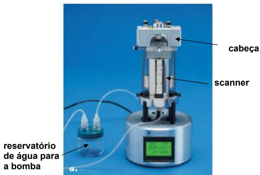
**Figura I-7** – AFM utilizado no Laboratório de Nanoscopia da UFMG
