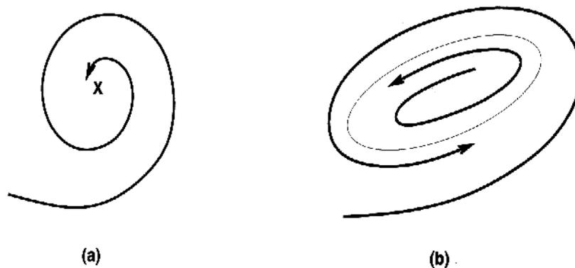
**Figura 3.1:** Atratores no plano: (a) ponto fixo e (b) ciclo limite (pontilhado).
