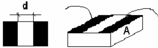
**Figura 2.1:** Ilustração esquemática das amostras utilizadas para medidas elétricas. Foram clivadas de GaAs SI crescidas por LT-MBE e tem-se  $d \sim 0,5$  mm e área da seção do filme  $A \sim 5,35 \times 10^{-5}$  cm<sup>2</sup>.
