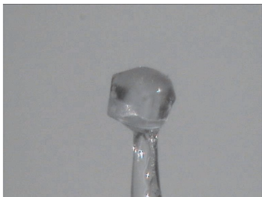
Figura 4.8: Foto de um dos cristais de K_2Mo_{0,5}W_{0,5}O_4 crescidos pelo nova técnica e medidos no difratômetro de monocristais.
