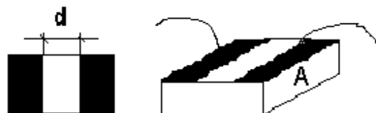
Figura 3.1: Ilustração esquemática das amostras utilizadas para medidas elétricas. Foram clivadas de GaAs SI crescidas por LT-MBE e tem-se d \sim 0,2 mm e área da seção do filme A \sim 3,64 \times 10^{-5} \text{cm}^2 .
