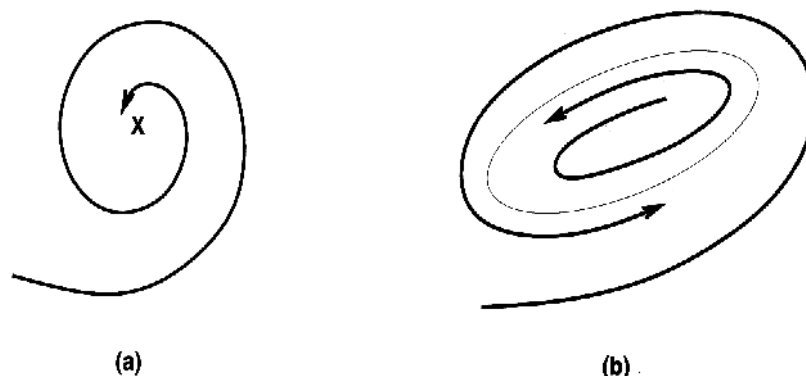
Figura 1.1: Atratores no plano: (a) ponto fixo e (b) ciclo limite (pontilhado).
