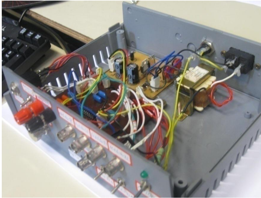
Figura 3.2: (a) Projeto do nosso Circuito de Chua com a fonte DC.
