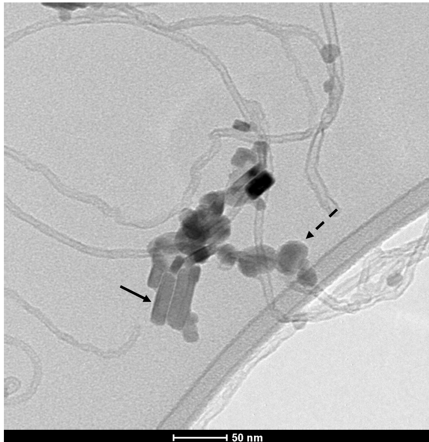
Figura 61: Imagem de TEM da amostra produzida de MWCNT decorados com \text{Cu}_x\text{S}_y . As setas tracejada e sólida indicam estruturas esféricas e cilíndricas respectivamente.
