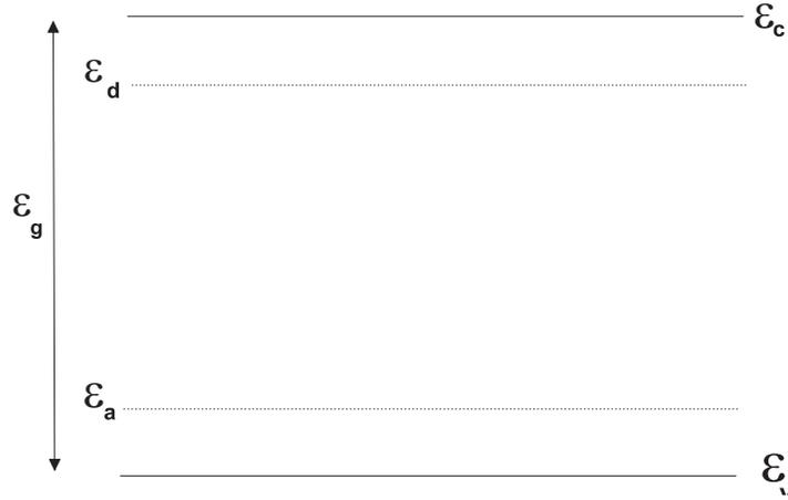
Figura 2.1: Digrama simplificado de um semicondutor, onde  $\varepsilon_{c(v)}$  significa energia da banda de condução (valência) e  $\varepsilon_{d(a)}$  é o nível de energia das impurezas doadoras (aceitadoras).  $\varepsilon_g$  é a energia de gap eletrônico.
