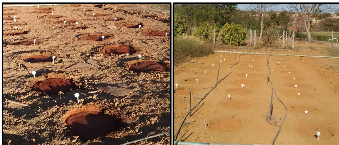
Figura 2. Unidades experimentais e covas preenchidas com os solos de diferentes texturas e lodo incorporado
