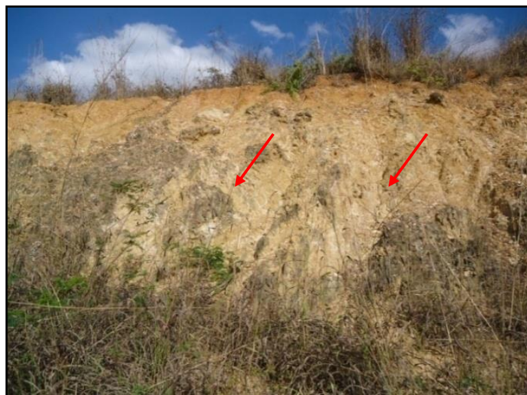
Figura 23: NEOSSOLO REGOLÍTICO Eutrófico típico. Notar feições erosivas do tipo ravina e horizonte Cr bastante erodível.
