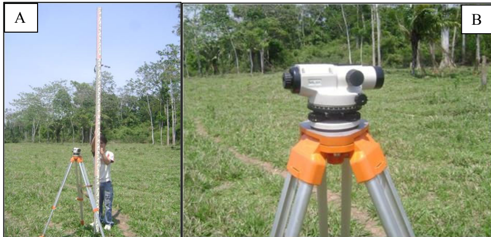
Figura 14 – Vista dos equipamentos utilizados para medida de declividade
