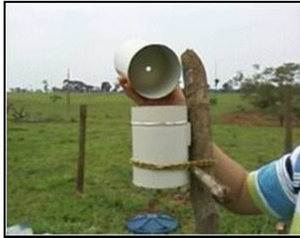
Figura 16 – Pluviômetro Ville de Paris instalado na área de estudo
