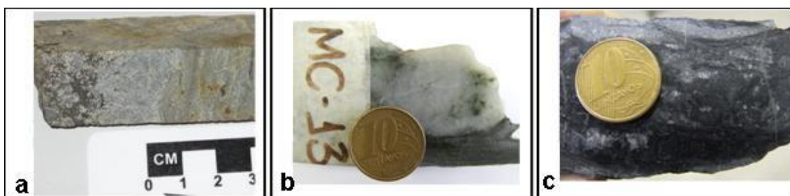
Foto 21 – Amostras de mão dos tipos de veio de quartzo e carbonato das zonas mineralizadas. a – veios em estágio intermediário de recristalização. Apresentam quartzo recristalizado, branco, e quartzo fumê, com carbonato subordinado. O mineral opaco na amostra é berthierita; b – veio de quartzo branco, recristalizado, com porções cloríticas; c – veio de quartzo fumê, deformado e carbonato.
