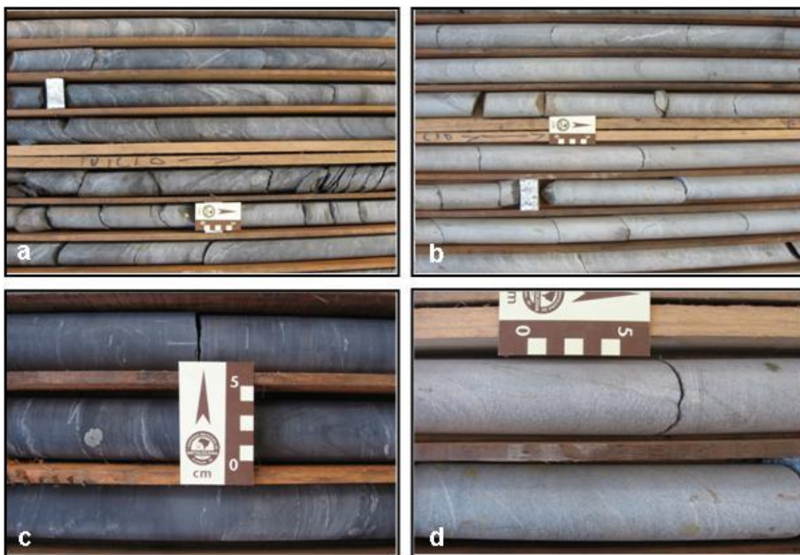
Foto 2 – Fotografias de testemunhos de sondagem exemplificando os litotipos predominantes da Unidade Córrego do Sítio na área do depósito homônimo. (a e c) intercalações de metapelitos e metassiltitos carbonosos. (b e d) intervalo métrico de metagrauvaca com menor contribuição carbonosa.
