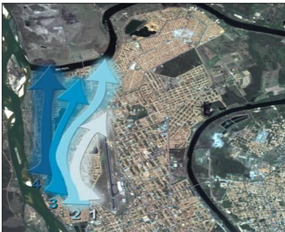
Figura 15 – Imagem de satélite mostrando antigos canais da planície aluvionar da barra do Poti
