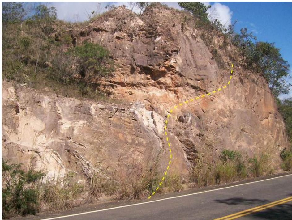
Figura 55- Afloramento em corte da rodovia BR367 (direção da estrada E-W) de camadas de metarenitos pelíticos laminados, mostrando dobra recumbente com vergência para leste.
