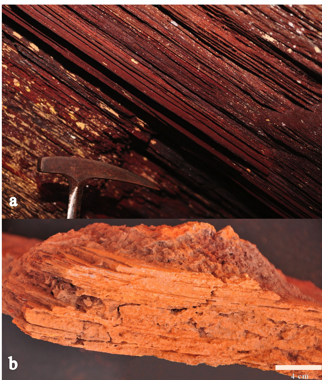
Figura 6.49 - Amostra BC-01: itabirito da Formação Cauê do tipo chapinha, com bandas milimétricas de hematita e sílica intercaladas.
