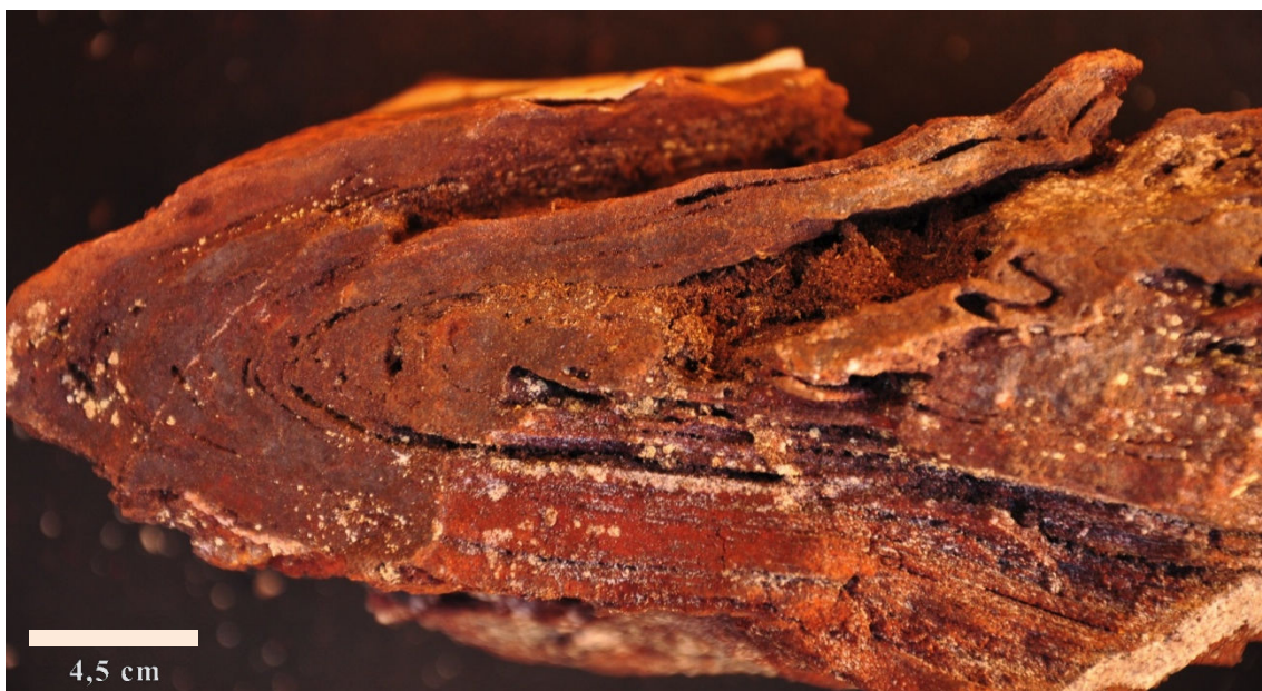
Figura 6.71 - Itabirito da Formação Cauê (amostra BC-05) coletado no interior da Caverna Cisalha. Largura máxima: 34 centímetros.
