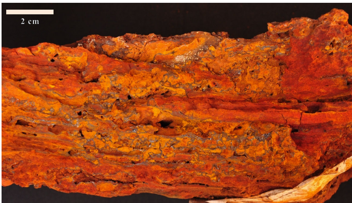
Figura 6.94 - Itabirito da Formação Cauê coletado no interior da Caverna Cabeceira do Prata (amostra GD-05): rocha alterada com presença de níveis de hematita recristalizada associadas a alvéolos.
