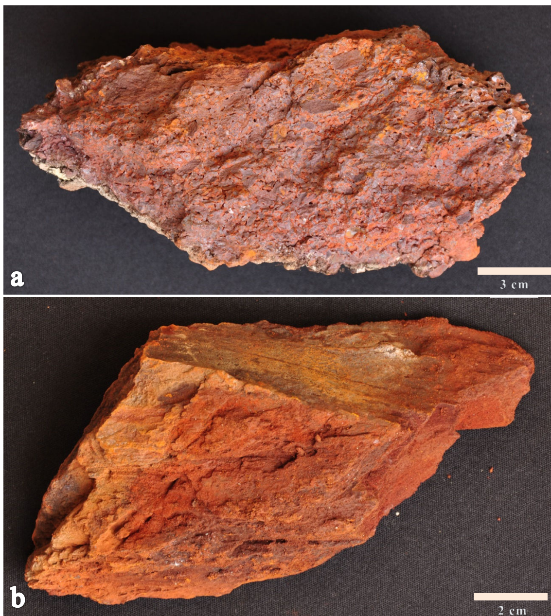
Figura 6.3 – Amostra SM-01 (a): Canga detrítica clastosuportada, com presença incipiente de matriz limonítica; (b) Amostra SM-02: Formação ferrífera bandada alterada, com bandas milimétricas de hematita, intercaladas por “vazios” reliquiares silicáticos.
