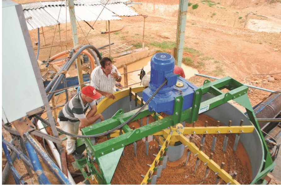
Figura 51: Equipamento utilizado na concentração do cascalho diamantífero na área de concessão da Petrus Mineração.
