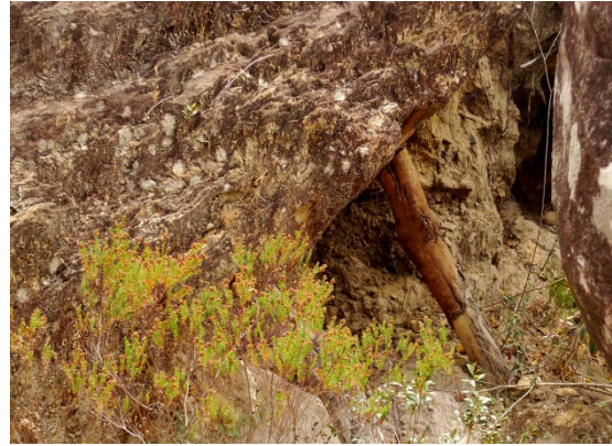
Figura 94: Escora utilizada no garimpo. Setembro de 2013.
