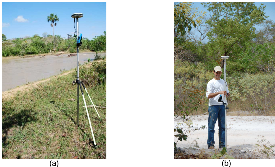
Figura 5.3: Aparelho receptor GPS L1. (a) aparelho em modo estático. (b) aquisição do ponto.
