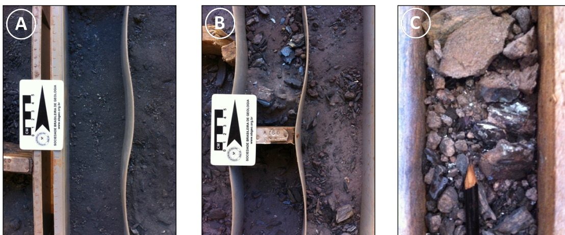
Figura 20. Fotomicrografias (A): Porção do itabirito friável totalmente pulverizado (FD521); (B): Porção do itabirito friável com presença de fragmentos (FD521); (C): Porção friável de um veio de quartzo contendo fragmentos de hematita lamelar.
