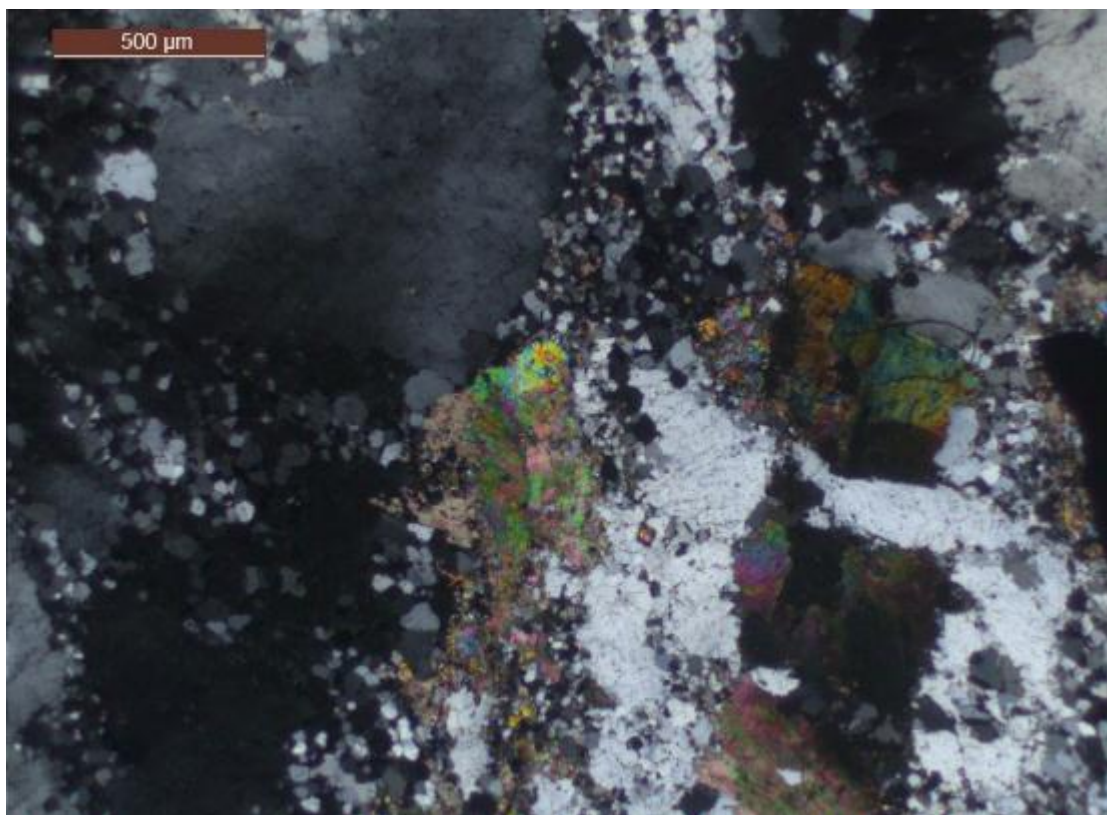
Fotomicrografia 3 – Amostra LCPD09-4 , 237,25 m- Qtz I (granulação grossa) com quartzo II (granulação fina) associado às bordas dos cristais. Luz transmitida, aumento de 2.5x.
