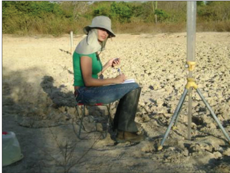
Figura 41 - Permeâmetro de Guelph: ensaio realizado na dolina Pedro Moura (Foto: Peter Fleming).
