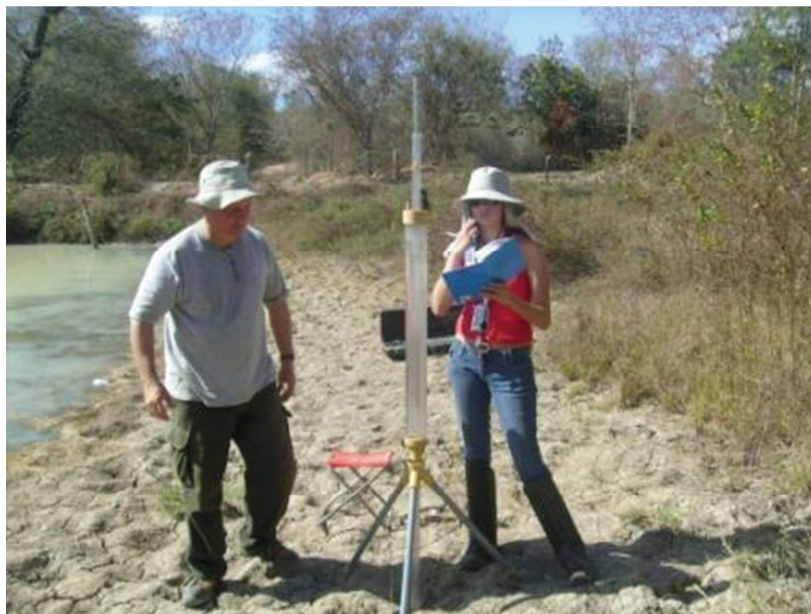
Figura 40 - Permeômetro de Guelph: ensaio realizado na dolina Santana (Foto: Geraldo Araújo).
