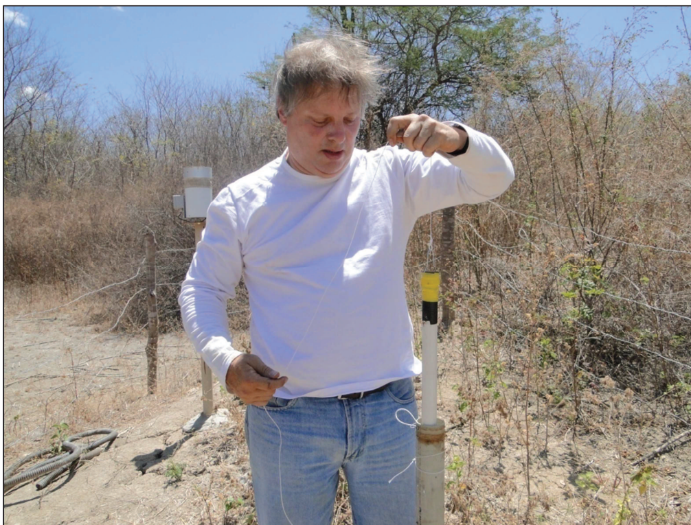
Figura 48 - Ensaio Slug Test com a introdução de um sólido de volume conhecido. Dolina Santana (Foto: Leticia Braga).
