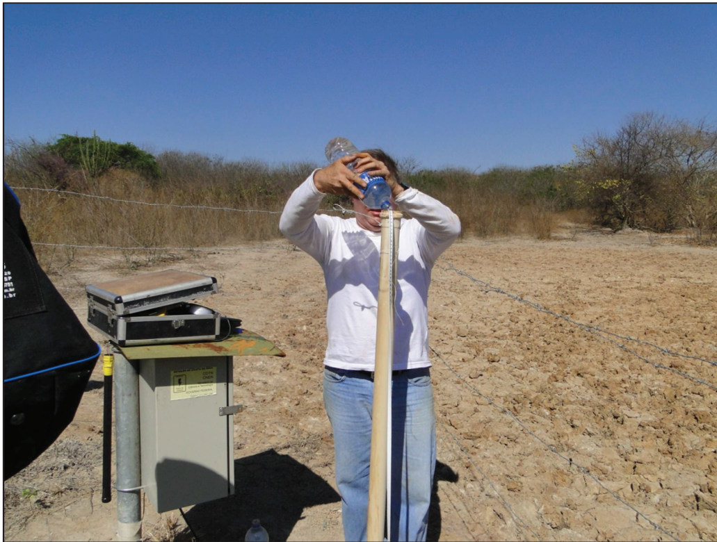
Figura 47 - Ensaio Slug Test com a introdução de água no poço. Dolina Pedro Moura (Foto: Leticia Braga).
