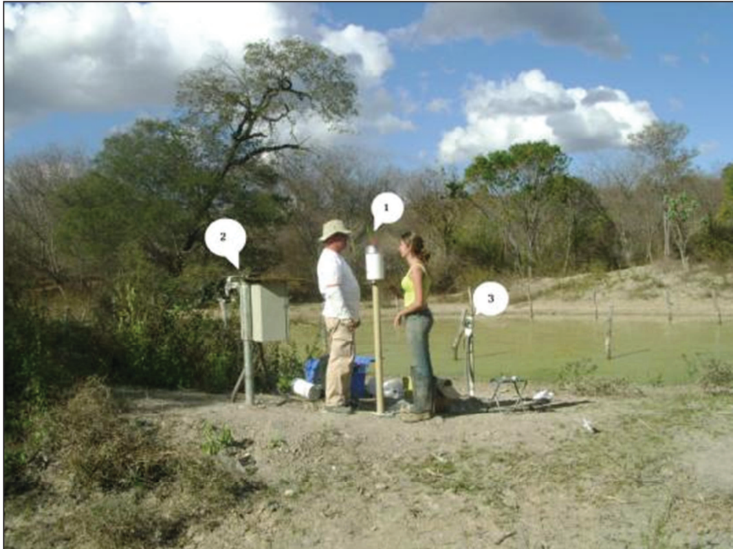
Figura 49 - Dolina Santana: 1- Pluviógrafo; 2 – Caixa de armazenamento dos dados e o baro e 3 – Poço de monitoramento (Foto: Geraldo Araújo).
