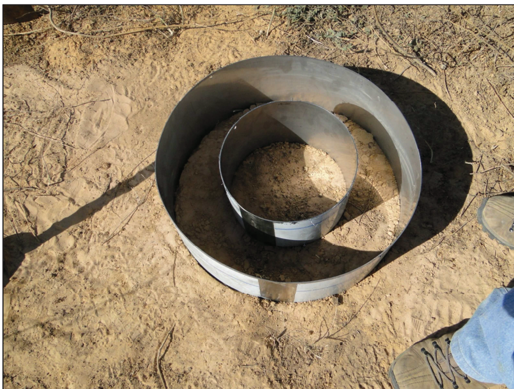
Figura 44 – Anéis duplos concêntricos cravados no solo. Dolina Pedro Moura (Foto: Leticia Braga).
