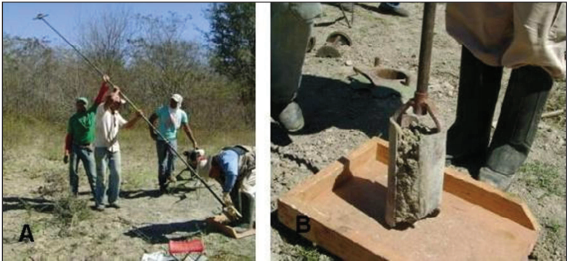
Figura 37 – Perfuração com trado motorizado na dolina Santana: A – Trado com 6 metros de alcance. B – Amostras de solo colhidas no fundo da dolina pelo trado (Foto: Letícia Braga).
