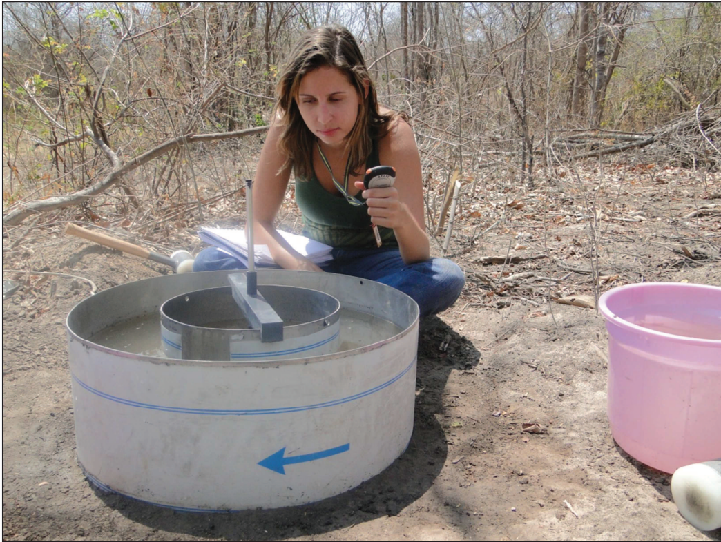
Figura 45 - Ensaio acontecendo: infiltrômetro de Anéis Duplos Concêntricos. Dolina Santana (Foto: Peter Fleming).
