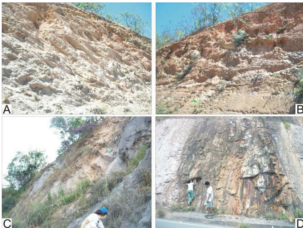
Figura 41 - A. Talude confinado com erosão condicionada pela foliação e ocorrência de deslocamento (MES013 - 23K 619244 x 7848684) B. Talude com foliação sub-horizontal e erosão (23K 616812 x 7839780) C. Formação de blocos (23K 620837 x 7787322) D. Formação de blocos (MES003 - 23K 622668 x 7784912)
