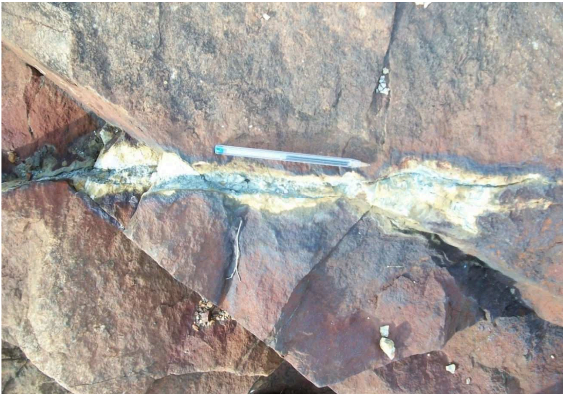
Figura 21 - Fratura em gnaissse preenchida por quartzo e sulfetos (MES059 - 23K 616019 x 7805337).
