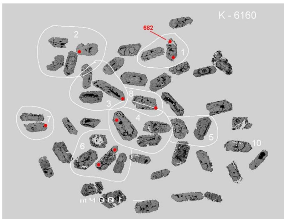
Figura III.3.2 – Imagem BSE de grãos de zircão da amostra 6160 mostrando os pontos analisados e a idade do sobre crescimento de xenotima ( $682$  Ma  $^{206}\text{Pb}/^{238}\text{U}$ ).
