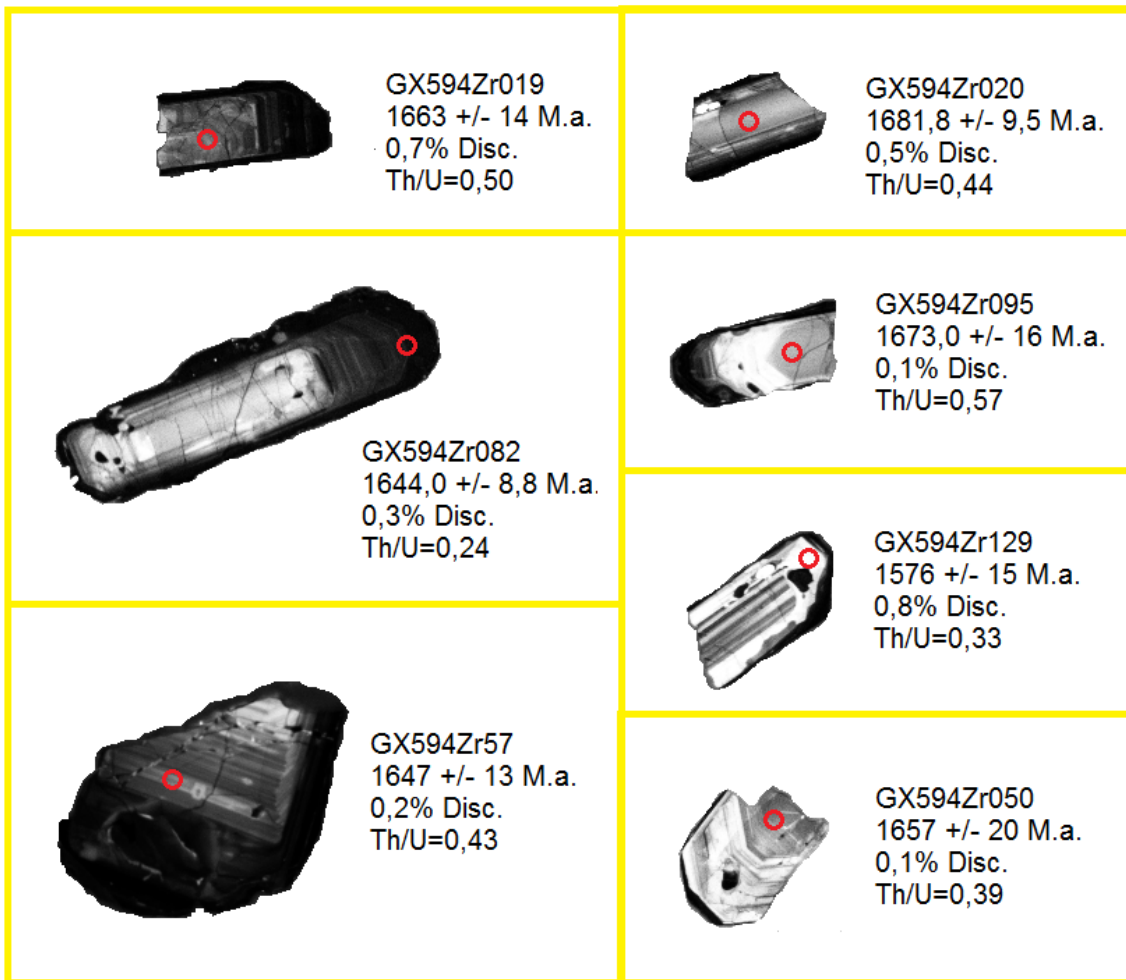
Figura 4. 12. Imagens de catodoluminescência de grãos de zircão do paragneisse da amostra GX-594, Unidade São Vicente. Spot: 25µm.
