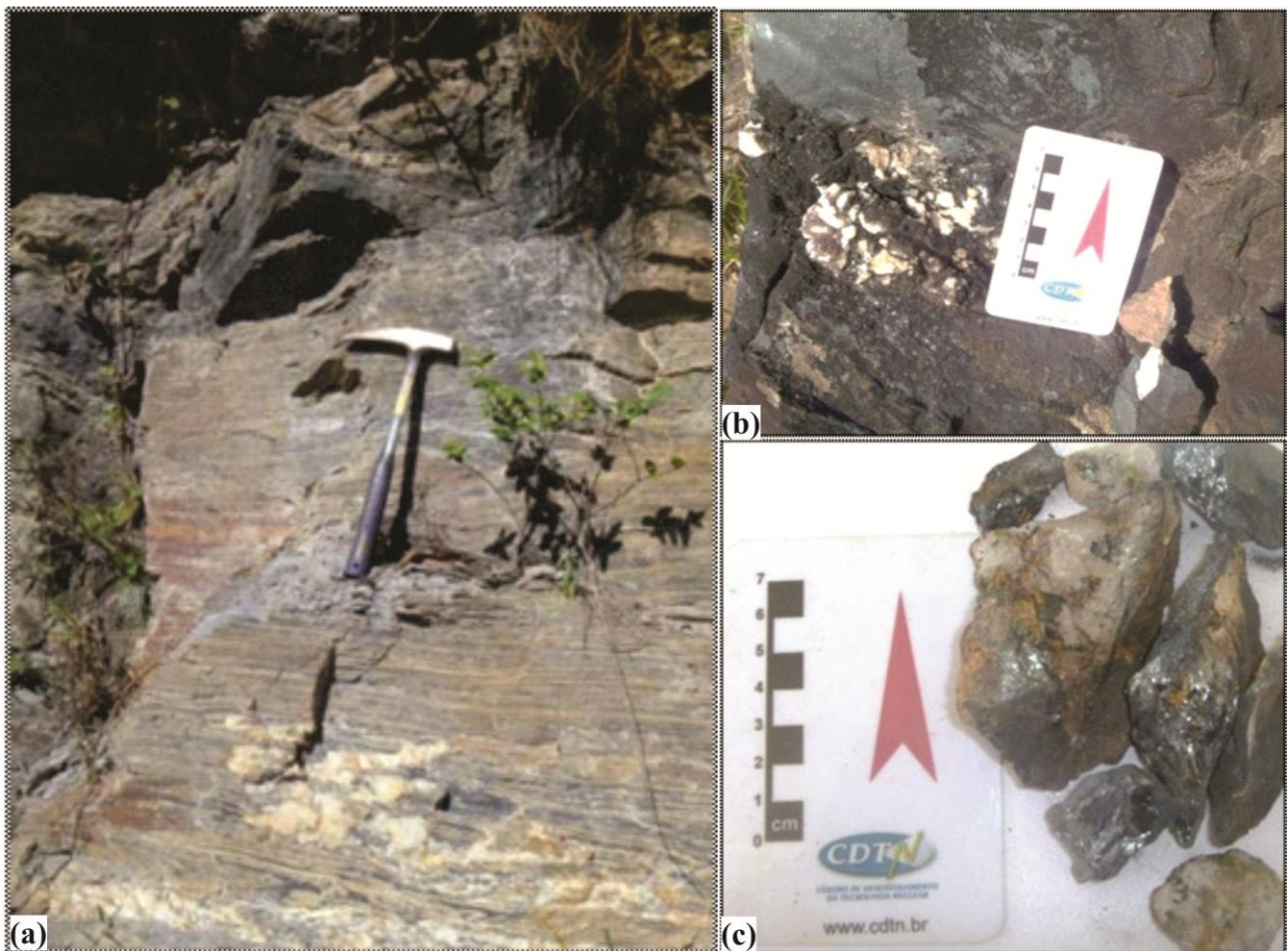
Figura 4.14. (a) Afloramento de itabirito quartzoso cortado por veio de quartzo, Morro do Pilar. (b) Afloramento de minério de ferro de alto teor compacto cortado por veio de quartzo leitoso com especularita, Morro do Pilar. (c) Amostra do veio de quartzo-especularita mostrado em (b).
