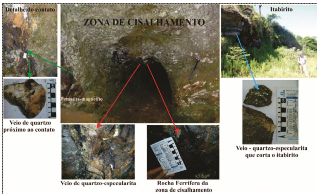
Figura 4.15. Imagem da zona de cisalhamento de Barão de Cocais mostrando o contato com o minério compacto e detalhes dos veios de quartzo e especularita que a cortam.
