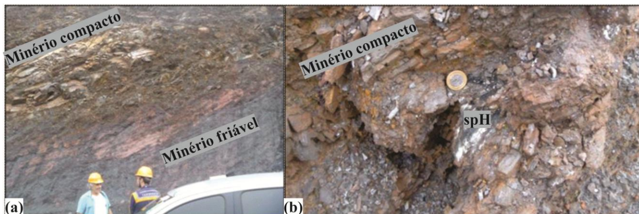
Figura 4.6. (a) Afloramento na mina de Pau Branco mostrando corpo de minério compacto dentro do minério friável. (b) Detalhe mostrando lente de especularita dentro do corpo de minério de Pau Branco.
