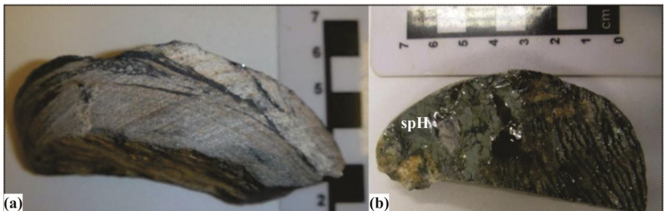
Figura 4.11. Imagem da amostra de itabirito quartzoso de Serro, SR01. (a) Observam-se as bandas da rocha truncadas por faixas de specularita. (b) Observação da superfície da amostra com destaque para os cristais de specularita de granulação grossa.
