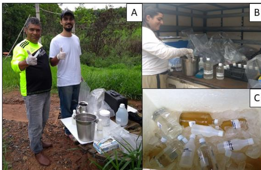
Figura III-3: A) Amostragem de água com utilização de luvas descartáveis e balde de aço inoxidável; B) Filtragem de amostra em membrana de 45 mesh; C) Preservação de amostras sob refrigeração até a entrega ao laboratório.
