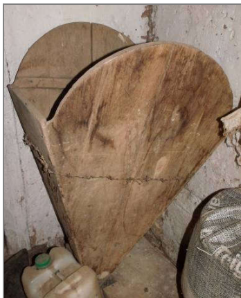
Figura 238: Moega – peça do moinho d’água.
