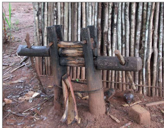
Figura 263: “Escaroçador de cana” encontrado na propriedade de Sr. Lídio.
