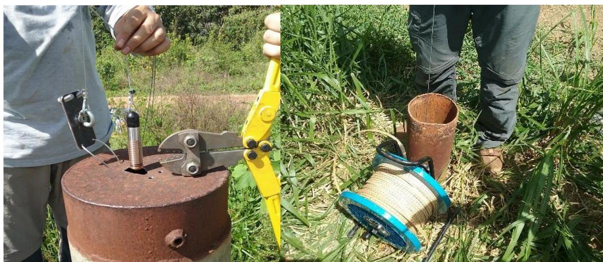
Figura 5.5: Transdutor de pressão usado para monitoramento automático dos poços (à esquerda) e de medidor manual de nível (à direita).
