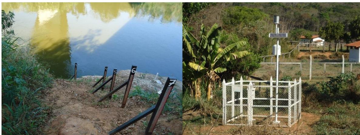
Figura 5.7: Estação fluviométrica e pluviométrica Raul Soares monitorada pela CPRM no curso a montante da área no rio das Velhas.
