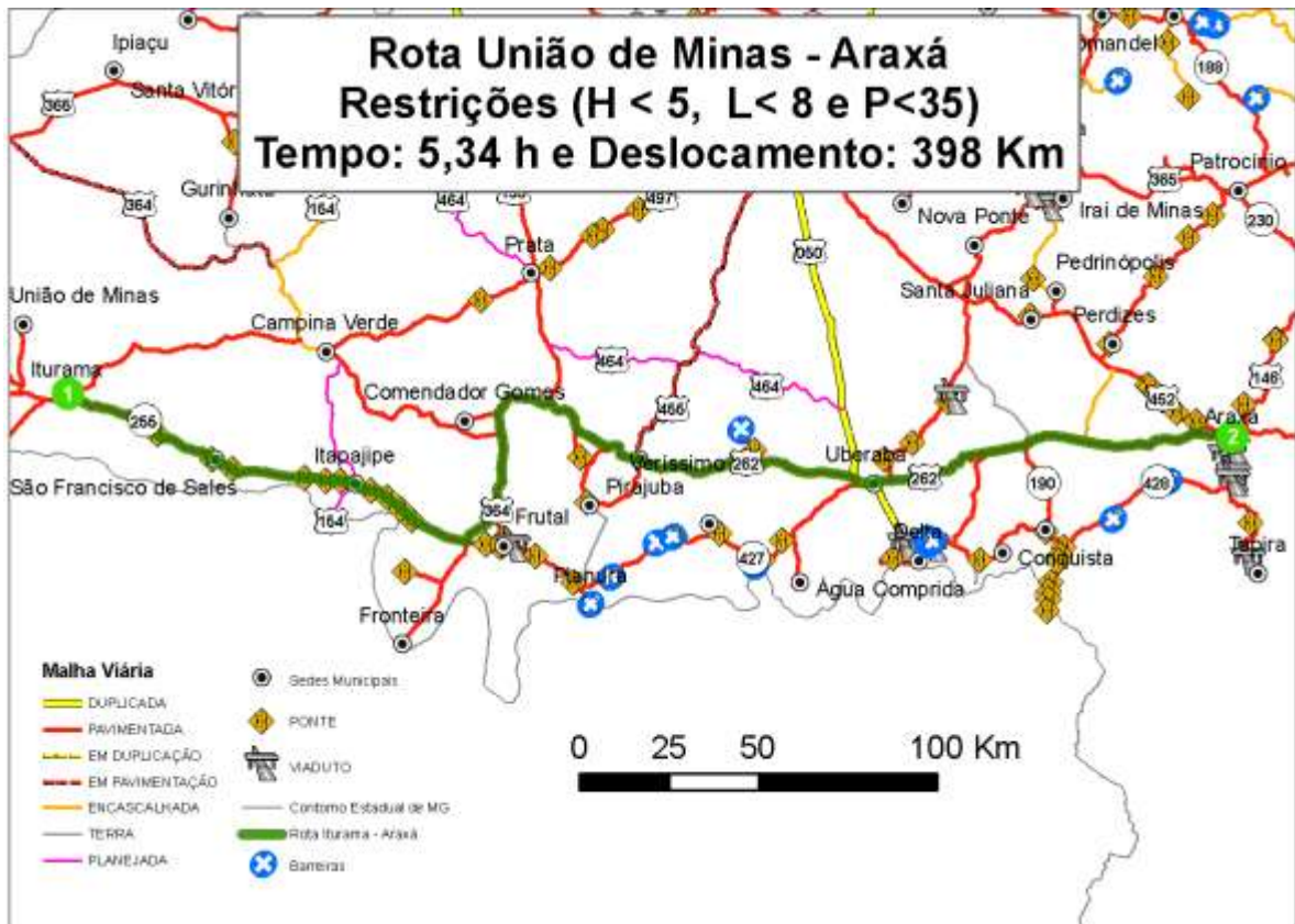
Figura 10 – Rota União de Minas – Araxá, considerando o melhor caminho com as restrições de altura, largura e peso propostas.
