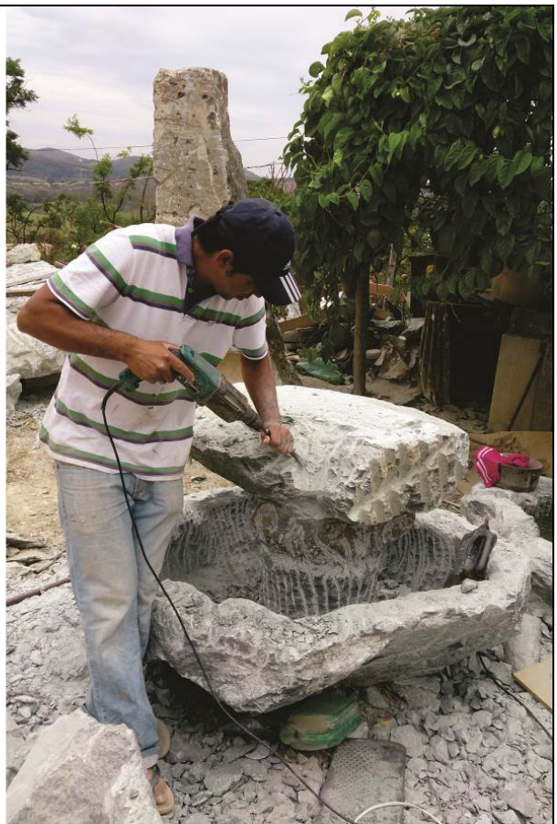
Figuras 26 e 27: Artesãos locais produzindo utensílios em pedra-sabão em seus ateliês, utilizando ferramentas rudimentares manuais (esquerda) e elétricas (direita).
