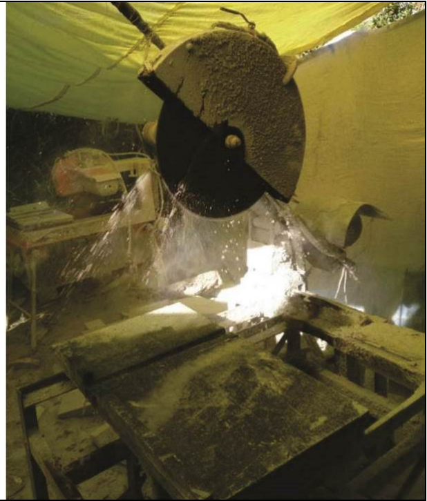
Figura 24 (esquerda): Manuseio da pedra-sabão com ferramentas rudimentares para a produção de uma fonte. Figura 25 (direita): Máquina elétrica de corte utilizada no processo de produção de utensílios em pedra-sabão.
