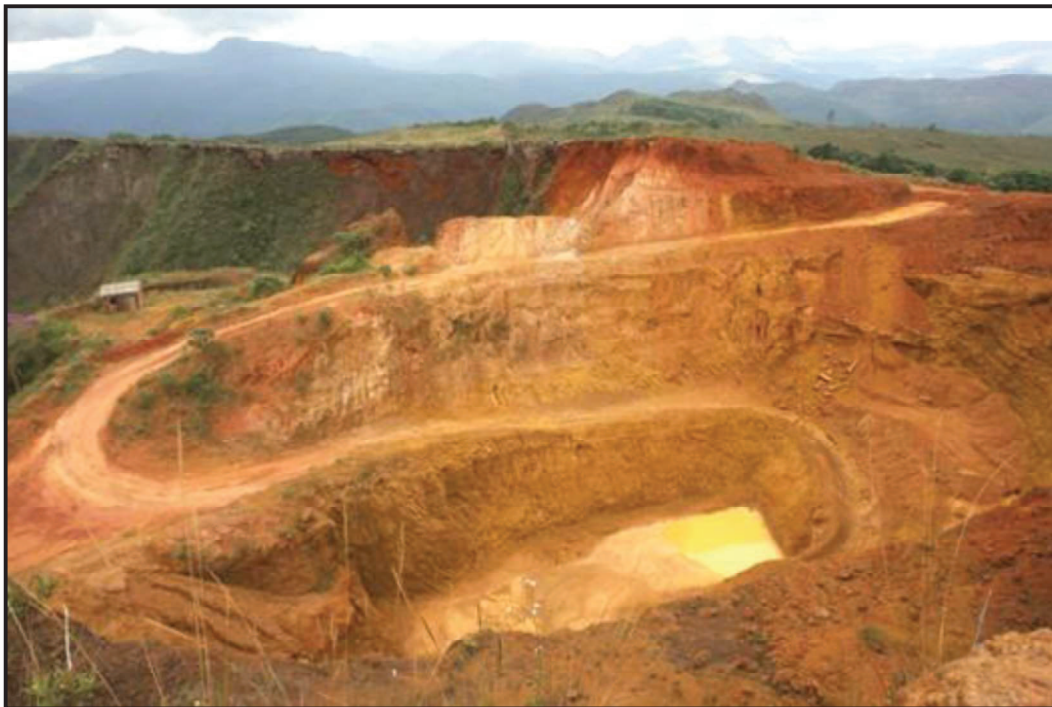
Figura 24 - Cava abandonada de ocre limonita
