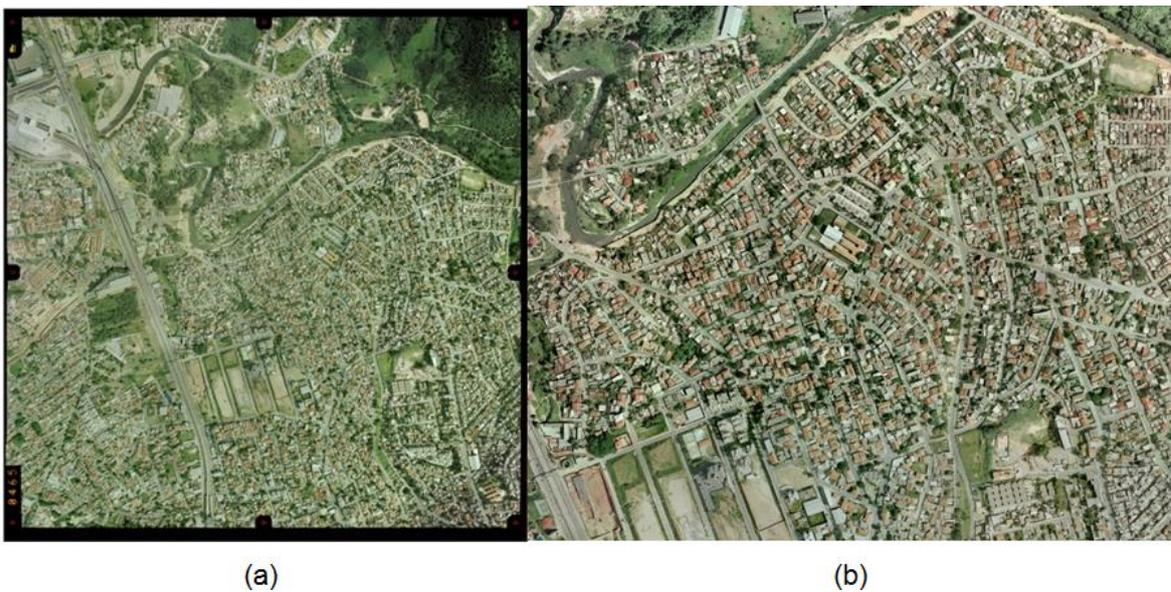
**Figura 2.** Produtos obtidos no levantamento aerofotogramétrico: (a) foto aérea e (b) foto aérea ortorretificada. Fonte: PRODABEL, 2008
