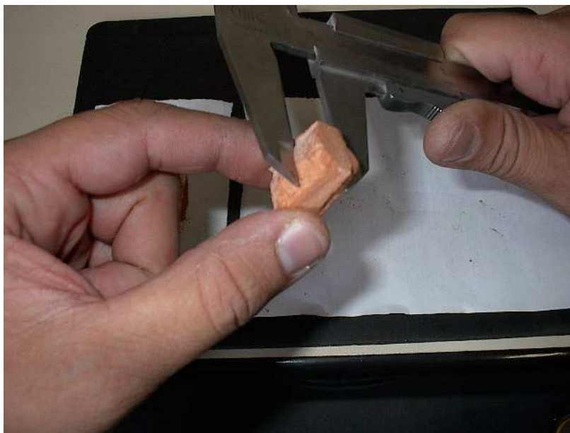
Figura 4.19 – Medidas sucessivas da espessura da amostra para avaliação da espessura da camada retirada por lixamento.
