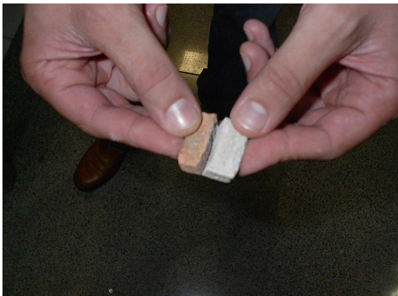
Figura 4.12 – Separação da amostra entre o revestimento argamassado e o bloco cerâmico.
