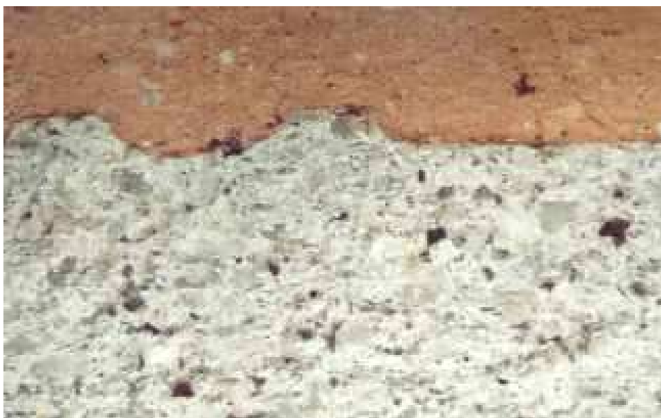
Interface bloco cerâmico/argamassa observada em lupa estereoscópica, na amostra cortada com serra cut-off. Aumento de 09x.
