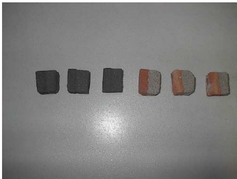
Figura 4.11 – Amostras após redução com serra manual (metalizadas e não metalizadas), com aproximadamente 30mm de comprimento, 24mm de largura e 14mm de altura.
