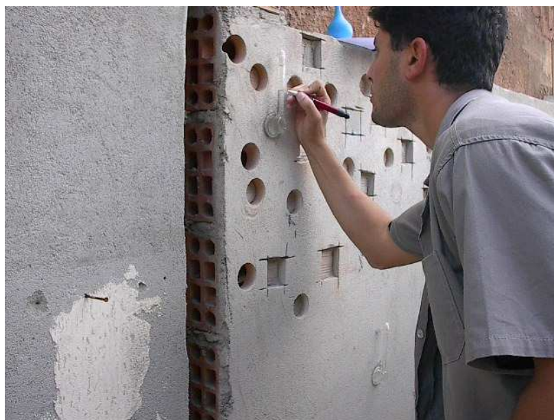
Figura 4.10 – Realização de leitura do ensaio no pescoço graduado do cachimbo.
