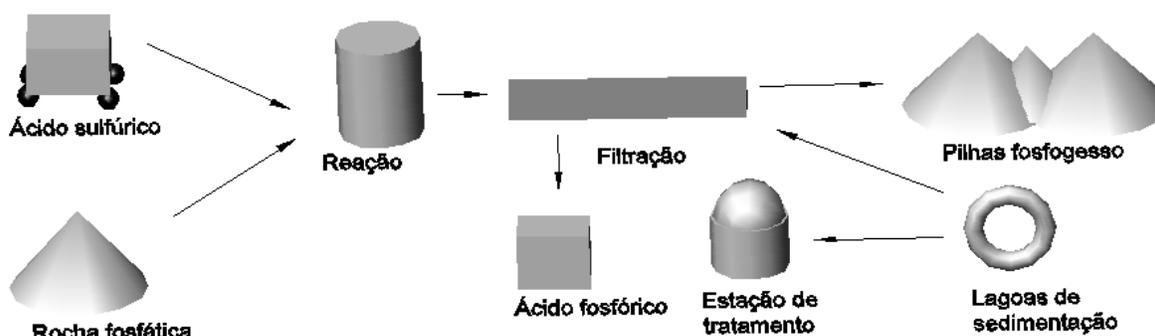
Figura 4.8 - Processo de produção de  $P_2O_5$  e geração do resíduo fosfogesso
