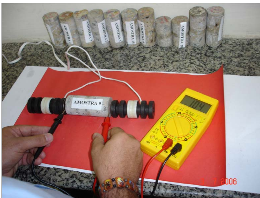
Figura 6.14: Ensaio de resistividade elétrica usando multímetro
