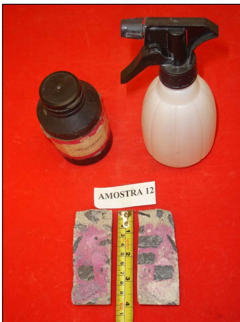
Figura 6.17: Medição da profundidade de carbonatação da amostra 12
