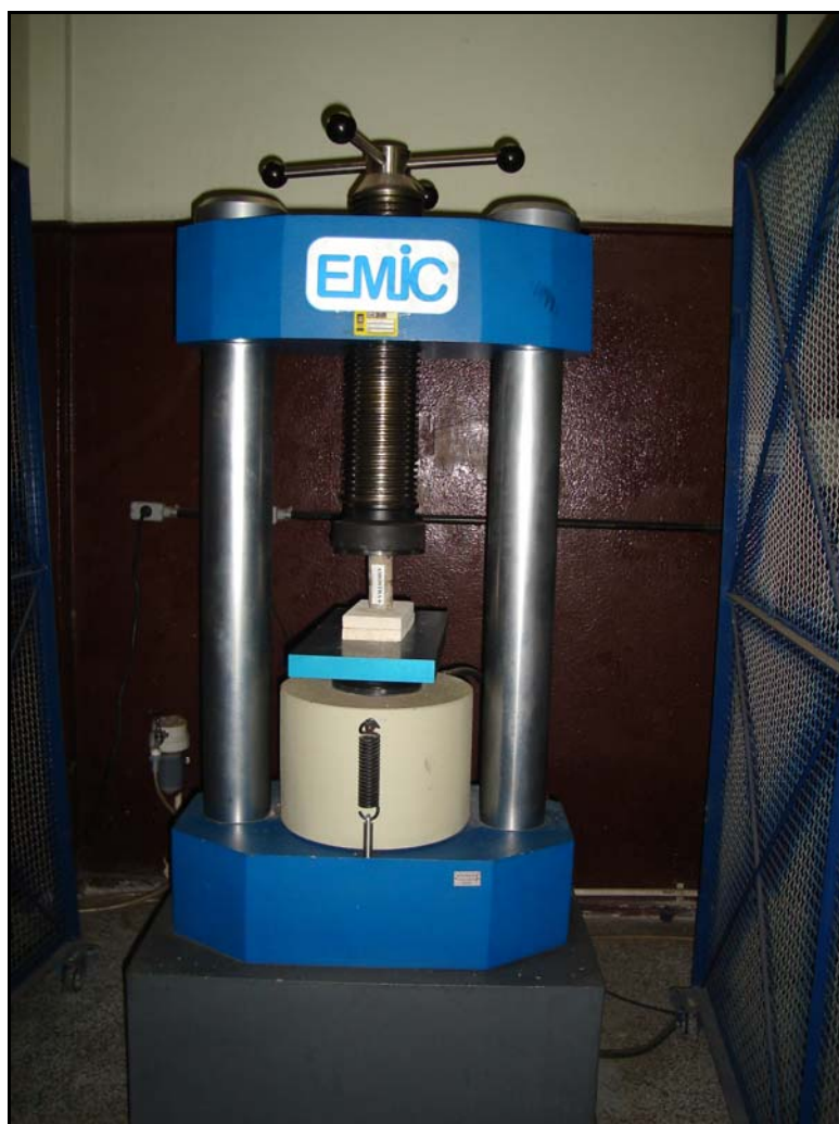
Figura 6.16: Rompimento à compressão das amostras na prensa Emic
