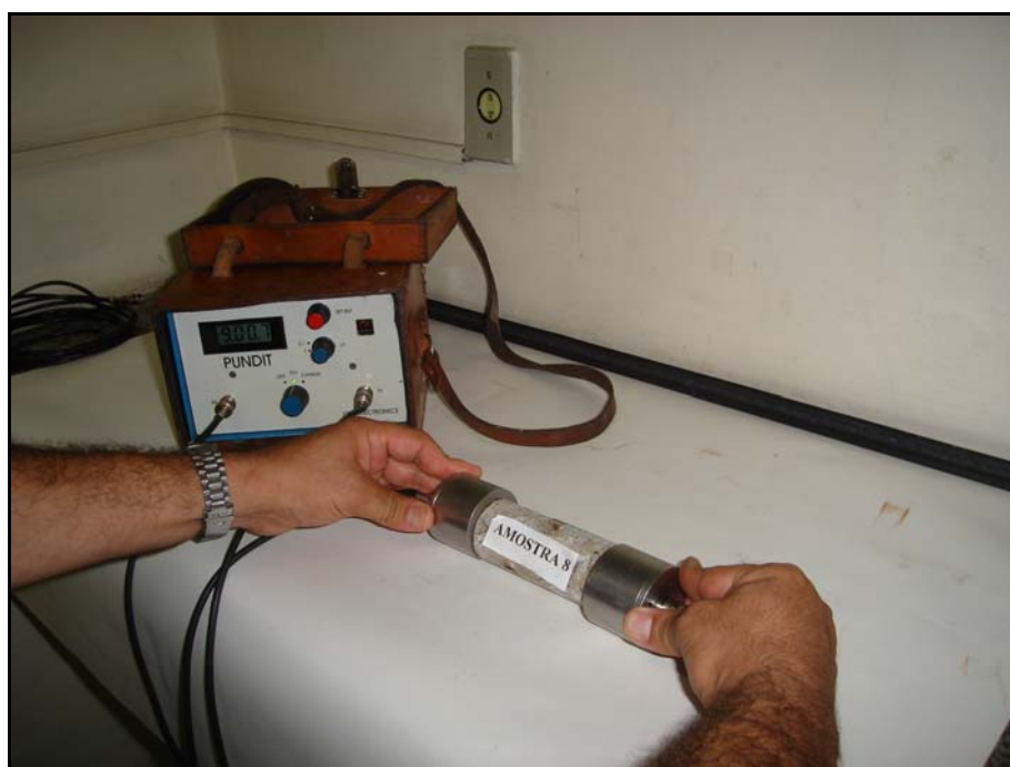
Figura 6.12: Ensaio de ultra-som utilizando o transdutor de 54 kHz
