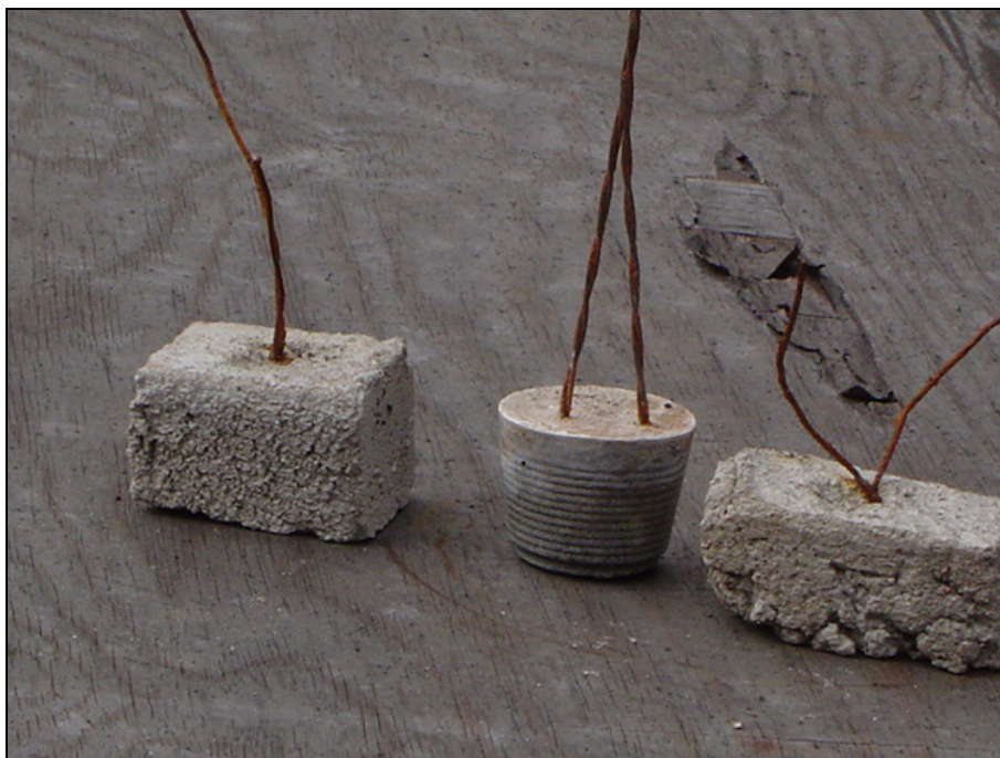
Figura 5.8: Pastilhas feitas com argamassa de baixa qualidade em contraste com pastilhas feitas com graute que atingem excelentes resultados
