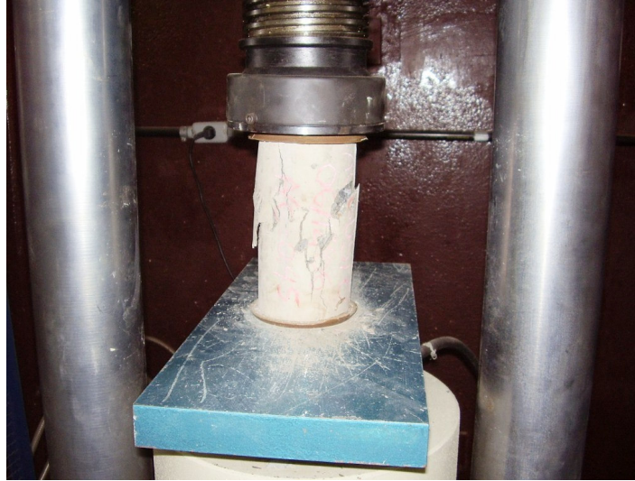
Figura 30 - Ruptura de corpo-de-prova capeado com enxofre
