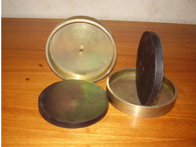
Figura 6 - Capeador elastomérico - Base metálica com anel de retenção e almofadas de neoprene
