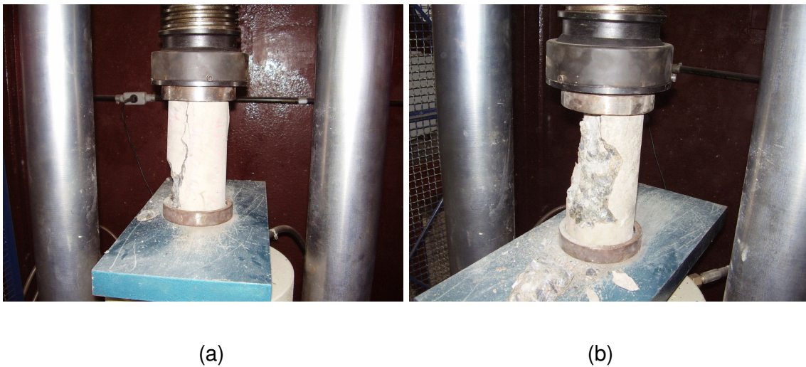
Figura 31 - Ruptura com capeamento elastomérico confinado
