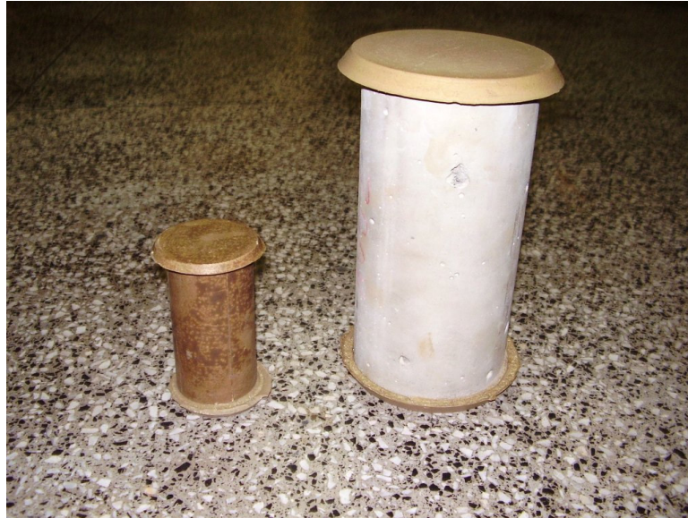
Figura 12 - Corpo-de-prova cilíndrico 50 x 100 mm de enxofre ao lado de um corpo-de-prova 100 x 200 mm de concreto
