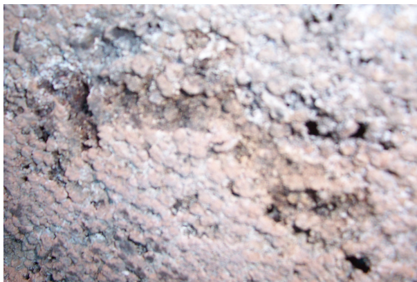
Figura 4.10: Aspecto macrográfico da amostra 3 após a sinterização.
