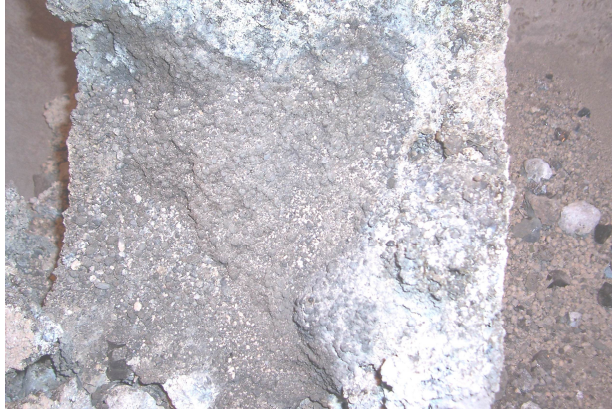
Figura 4.7: Aspecto macrográfico da amostra 2 após a sinterização.
