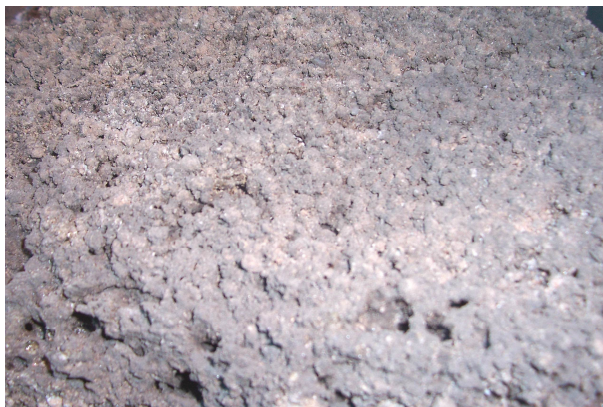
Figura 4.13: Aspecto macrográfico da amostra 4 após a sinterização.
