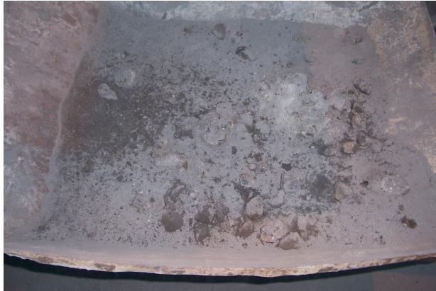
Figura 4.3: Aspecto macrográfico da amostra 1 após a sinterização.
