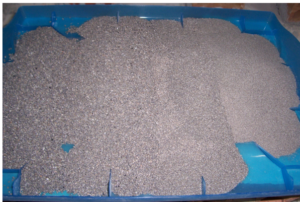
Figura 3.2: Areia sinterizada utilizada na confecção das argamassas, nas seguintes granulometrias: 1,2; 0,6; 0,3 e 0,15 mm.
