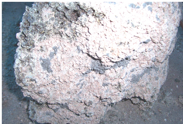
Figura 4.17: Aspecto macrográfico da amostra 5 após a sinterização.
