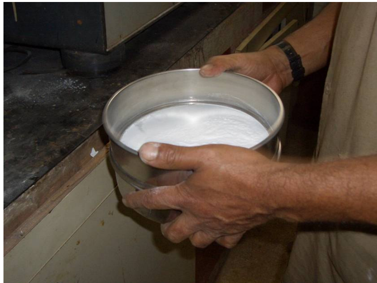
Figura 85 – Peneiramento, na peneira # 200, da granitina grossa já moída.
