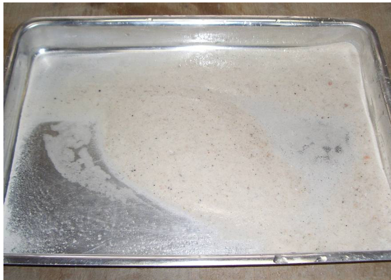
Figura 101 – Material retido na peneira 0,075 mm no ensaio a úmido da NBR NM 46 (ABNT, 2003b).
