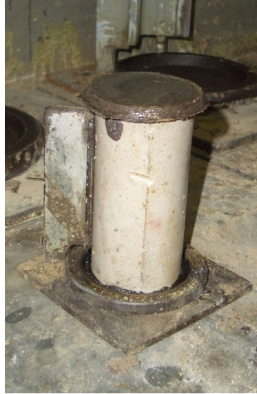
Figura 68 – Capeamento de CP com mistura de enxofre.
