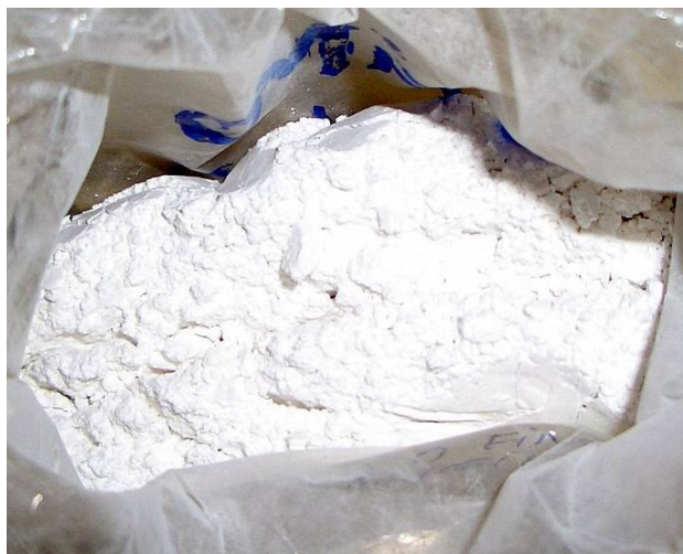
Figura 105 – Amostra de granitina grossa após moagem e peneiramento.
