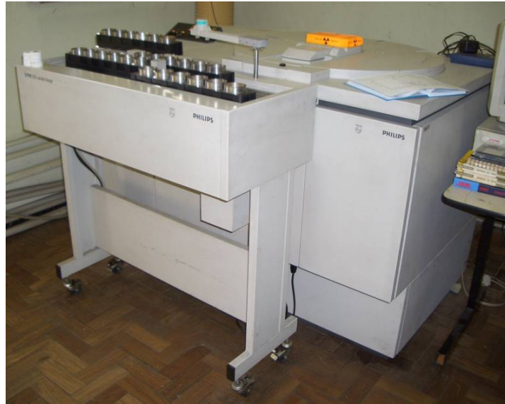
Figura 90 – FRX sendo realizada no espectrômetro de raios-X PHILIPS PW-2510.
