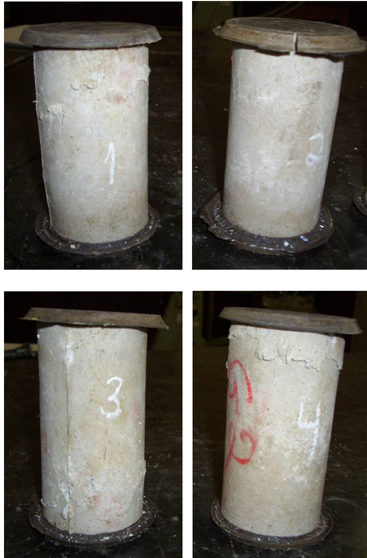
Figura 94 – CP's com relação água/aglomerantes de 0,19 após o rompimento na prensa.
