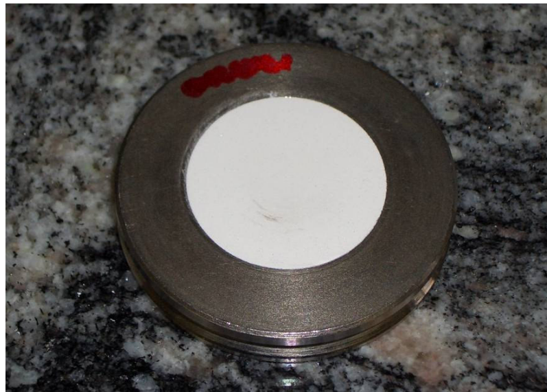
Figura 88 – Detalhe do porta-amostras com uma camada fina de pó-de-pedra compactado, já pronto para ser encaminhado ao difratômetro.
