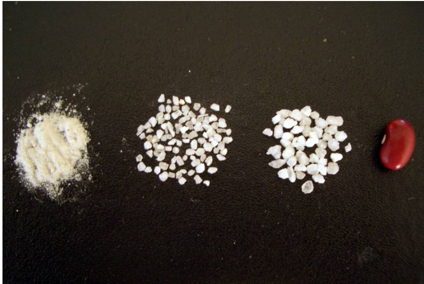
Figura 39 – Amostras do pó-de-pedra (esquerda), da granitina fina (meio) e da granitina grossa (direita), componentes do revestimento de restauro da fachada.
