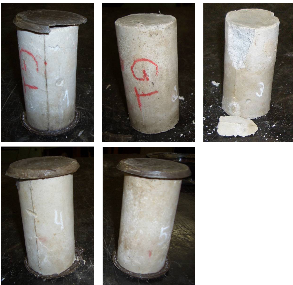
Figura 93 – CP's com relação água/aglomerantes de 0,22 após o rompimento na prensa.
