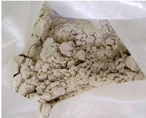
Figura 103 – Amostra de pó-de-pedra após moagem e peneiramento.
