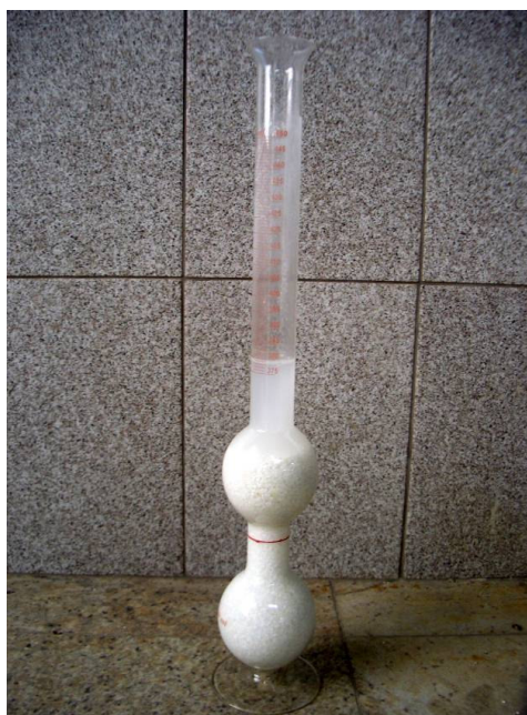
Figura 82 – Ensaio de massa específica da granitina grossa no frasco Chapman.
