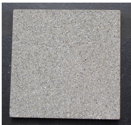
Figura 22 – Amostra do aspecto da argamassa utilizada para a restauração do revestimento da figura anterior.
