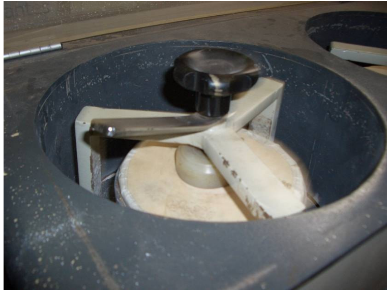
Figura 84 – Câmara do moinho de disco orbital TECNAL TE-360.
