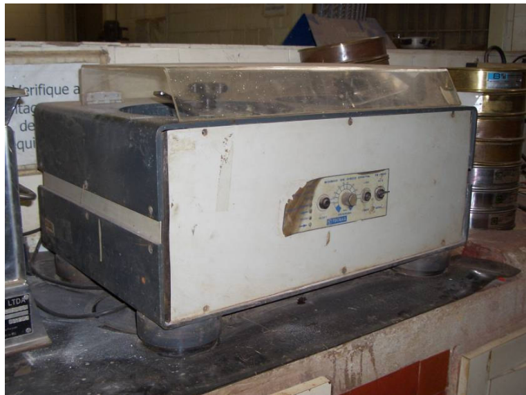
Figura 83 – Moagem de uma amostra de material no moinho de disco orbital TECNAL TE-360.
