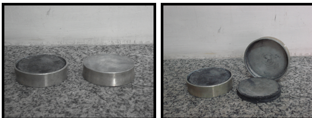
Figura 5.7 – Disco de neoprene – substitui capeamento com enxofre
