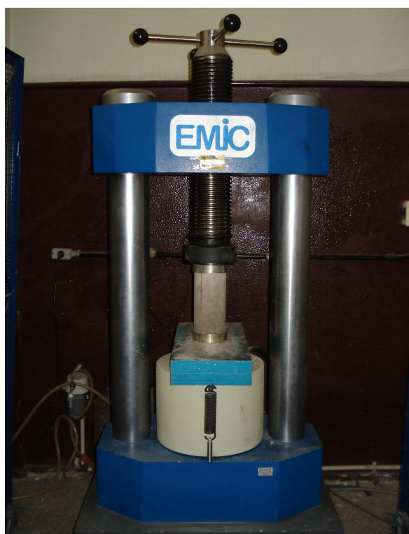
Figura 5.9 – Prensa Hidráulica de 200 t.f de capacidade
