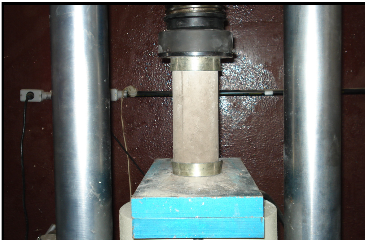
Figura 5.8 – Regularização de face com disco de neoprene
