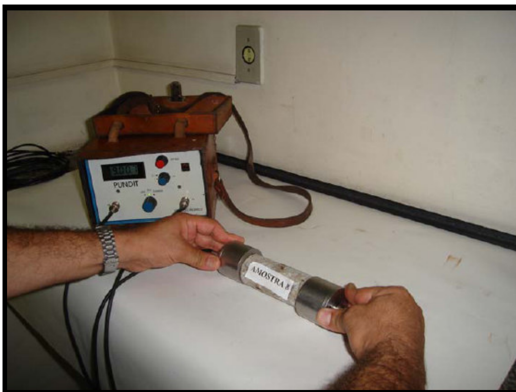
Figura 5.3 – Ensaio de ultra-sonografia, com transmissão direta Fonte: AGUIAR, 2006
