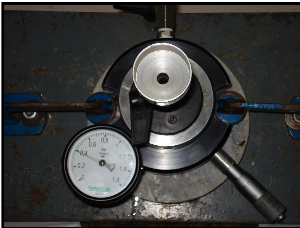
Figura 5.6 – Manômetro indicando pressão no sistema igual a 0,4 Bar
