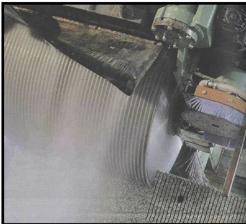
Figura 4.6 – Resíduo gerado no corte dos blocos
