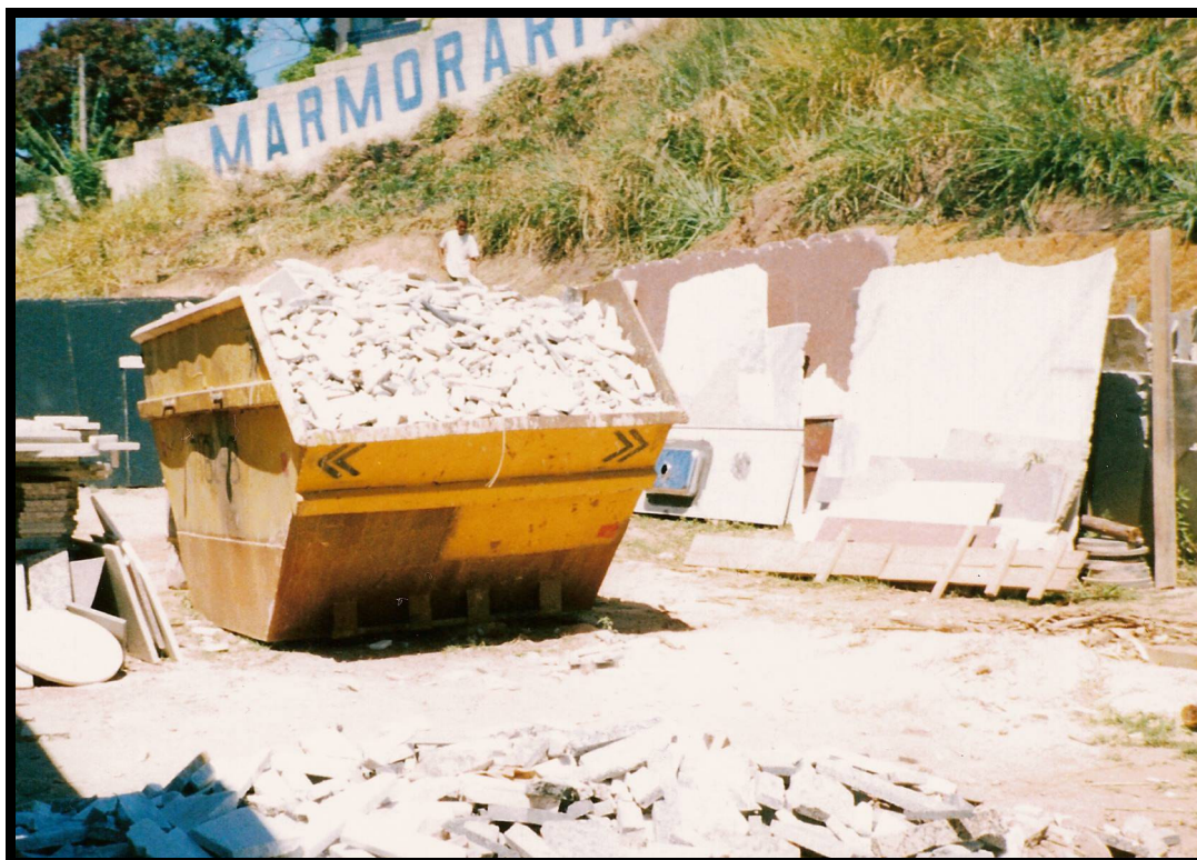
Figura 4.8 – Resíduo gerado no corte das placas – Aparas em formas irregulares
