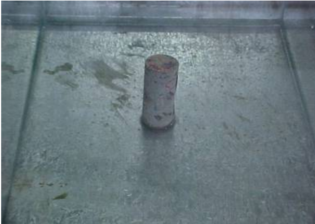
Figura 21 – Absorção por capilaridade. Corpo-de-prova em lâmina de água
