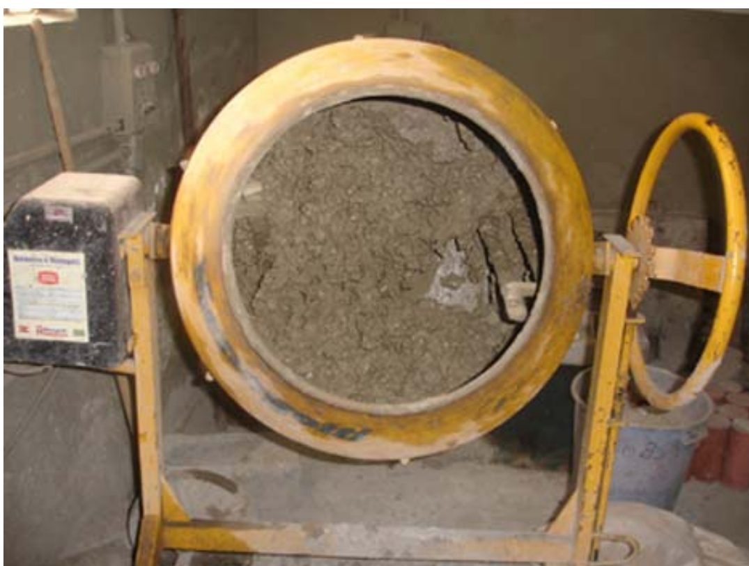
Figura 12 – Concreto sendo misturado na betoneira – Laboratório de Concreto da UFMG
