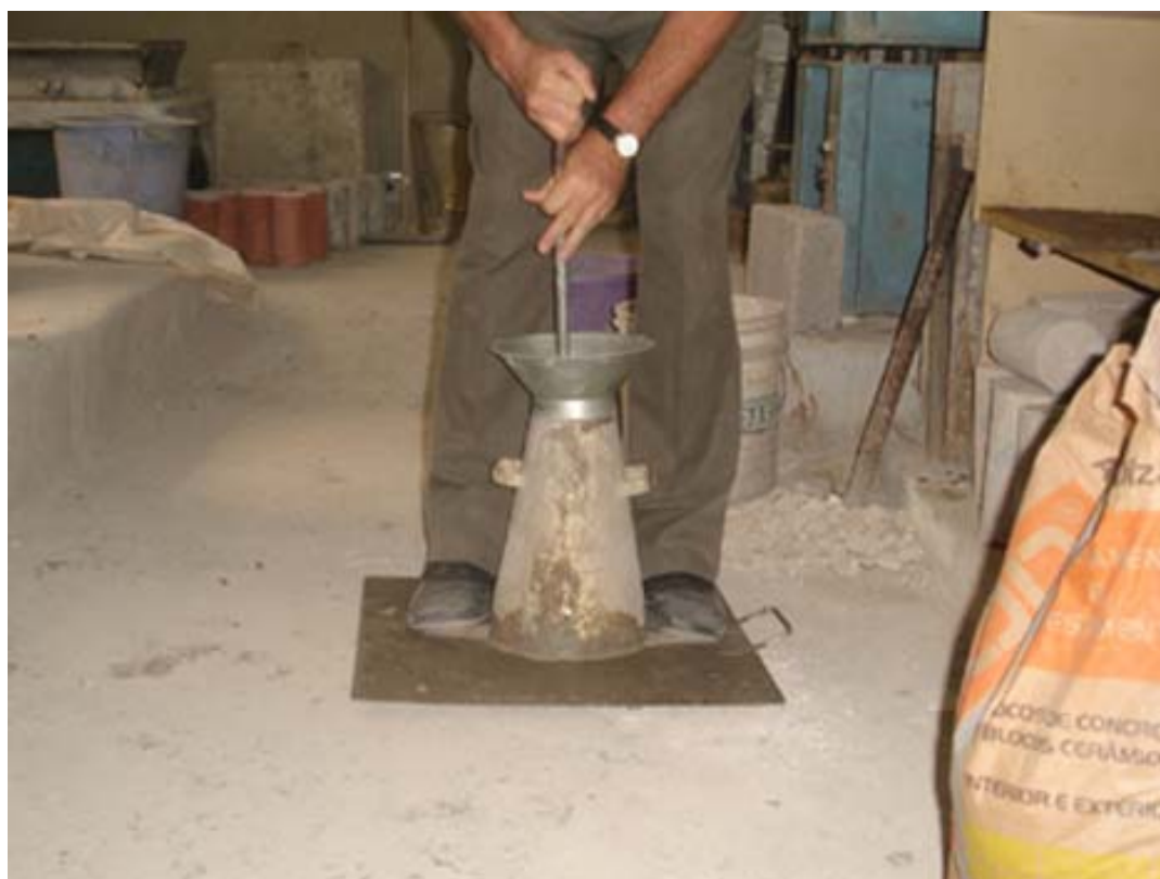
Figura 11 – Slump Test feito no laboratório de concreto da UFMG
