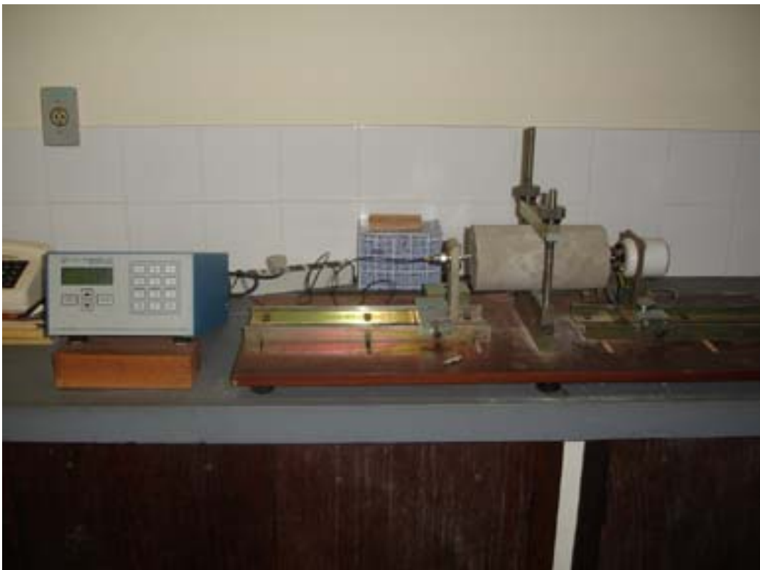
Figura 19 – Avaliação do módulo de elasticidade dinâmico do corpo-de-prova de concreto
