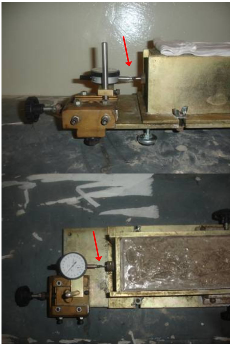
Figura 17 – Fixação do relógio comparador na extremidade do pino de contato
