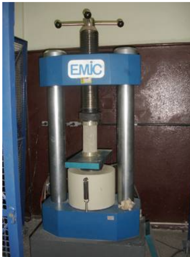
Figura 18 – Prensa hidráulica utilizada no rompimento dos corpos-de-prova cilíndricos
