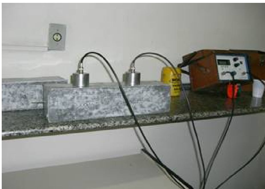
Figura 23 – Prisma de concreto sendo submetido ao ensaio de ultra-sonografia
