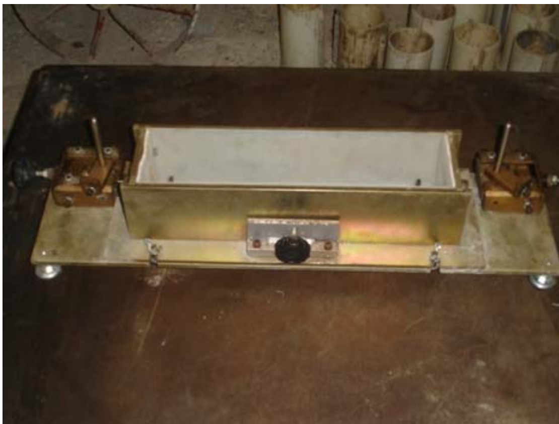
Figura 13 – Forma para avaliação da retração autógena já com o isolamento em suas faces
