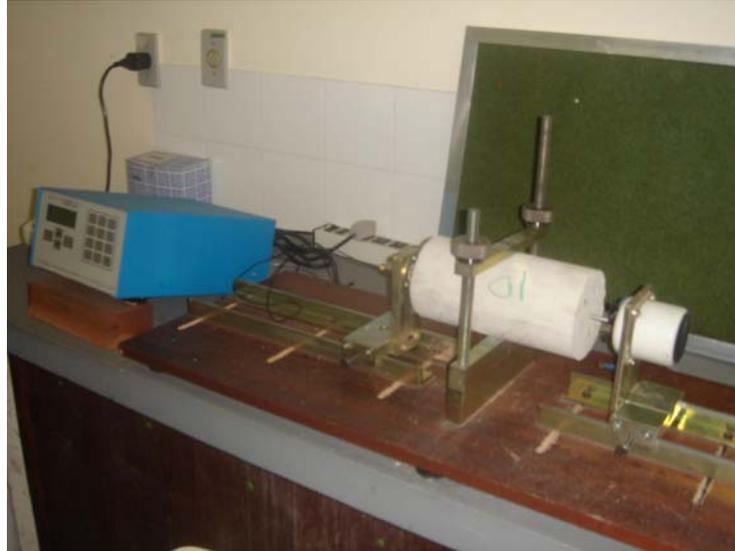
Figura 71 – Ensaio de módulo de elasticidade dinâmico longitudinal.
