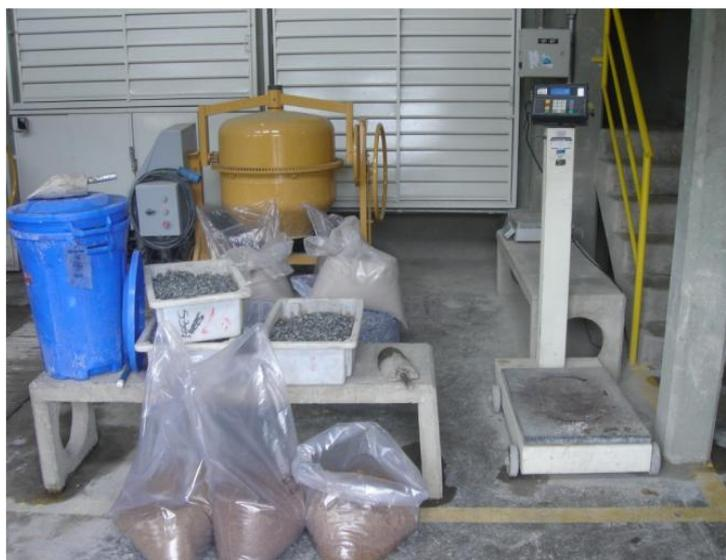
Figura 55 – Pesagem do material para composição do traço do concreto.
