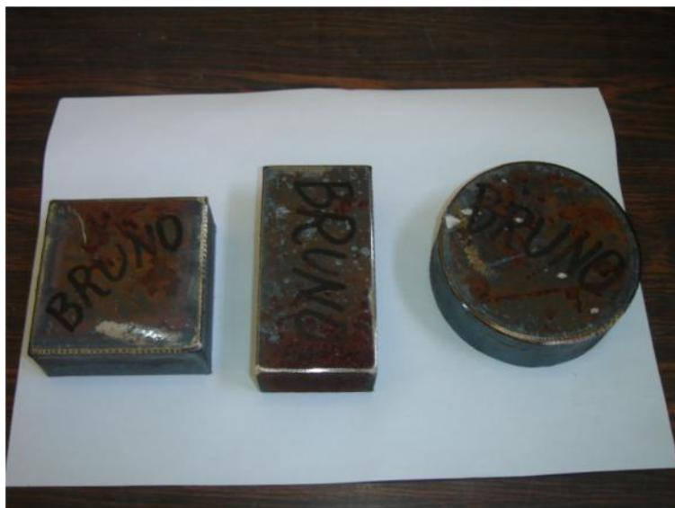
Figura 59 – Matrizes fabricadas para empurrar o núcleo de concreto nos ensaios.
