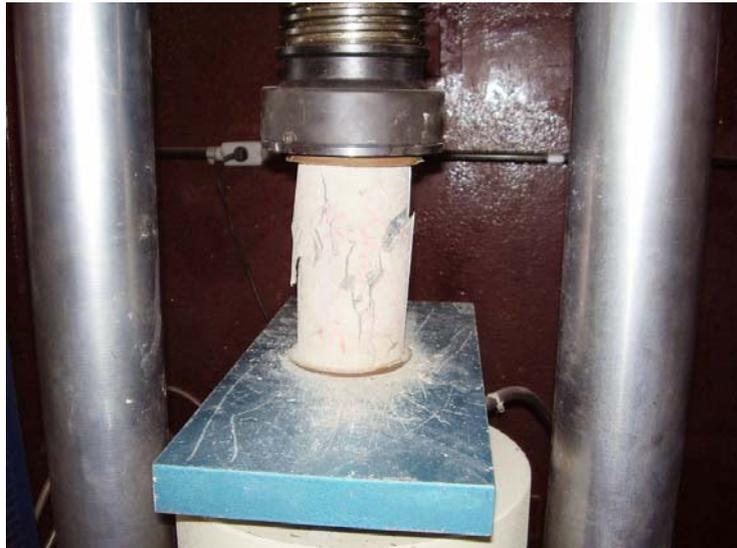
Figura 77 – Ruptura do CP1, capeado com enxofre, aos 14 dias de idade.
