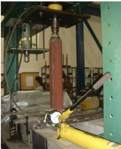
Figura 66 – Detalhe da bomba manual ligada ao atuador hidráulico.
