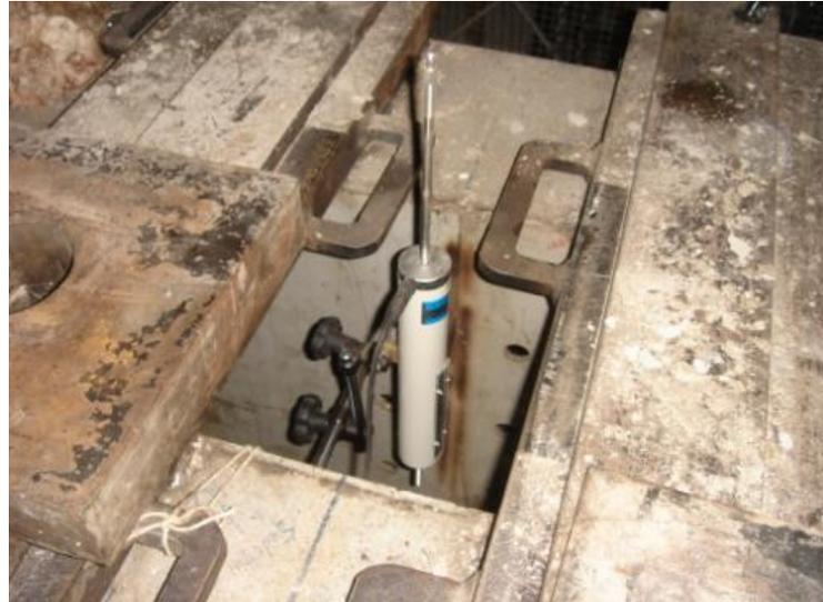
Figura 62 – DT utilizado para medir o deslizamento do concreto no interior dos tubos.
