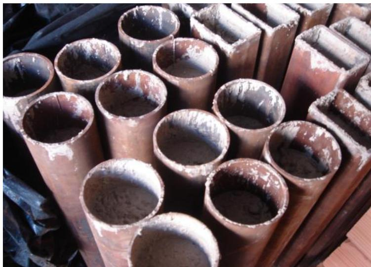
Figura 58 – Preenchimento com concreto dos perfis tubulares.
