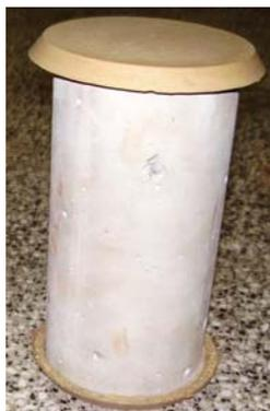
Figura 57 – Corpo-de-prova de concreto para o ensaio à compressão.
