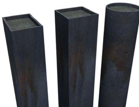
Figura 50 – Modelos de pilares mistos sem a formação da pátina interna.
