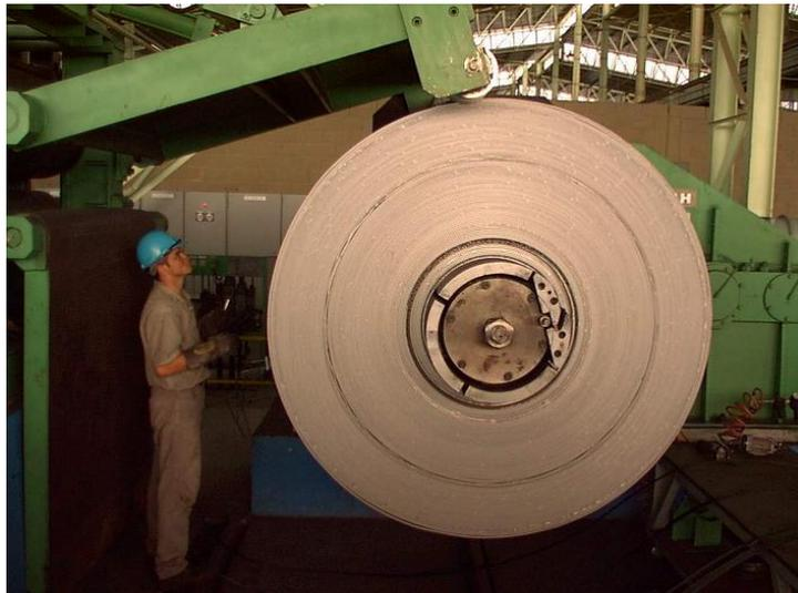
Figura 21 – Rebobinamento das tiras de aço cortadas (USIMINAS, 2008).
