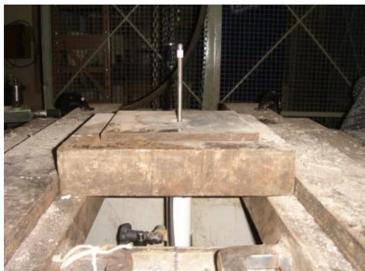
Figura 63 – Chapa de apoio para os ensaios e proteção do DT.
