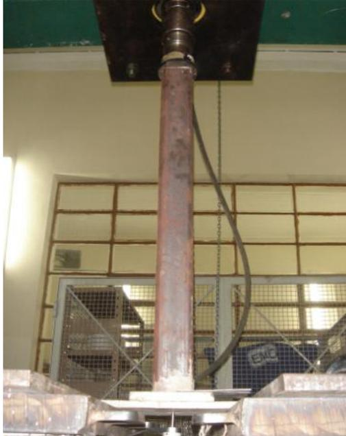
Figura 64 – CP retangular sem pátina preparado para ensaio.
