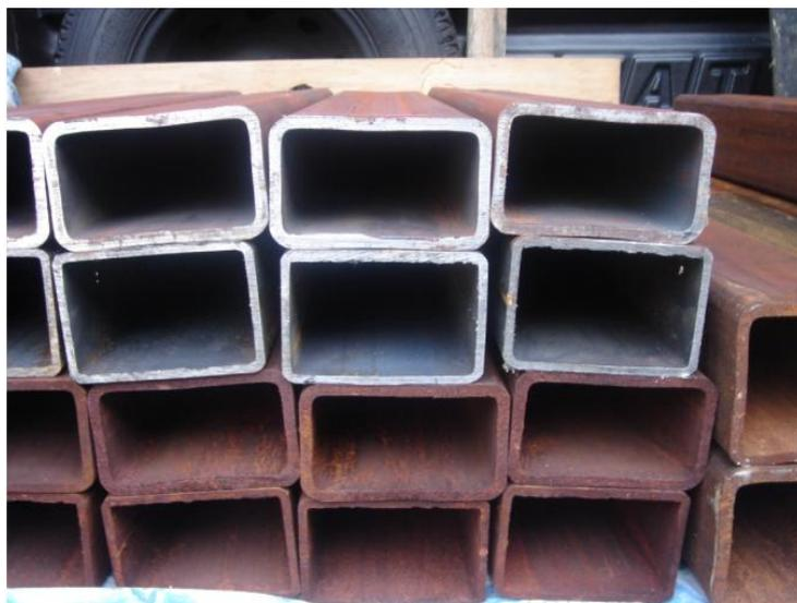
Figura 53 – Tubos retangulares com e sem formação de oxidação interna.
