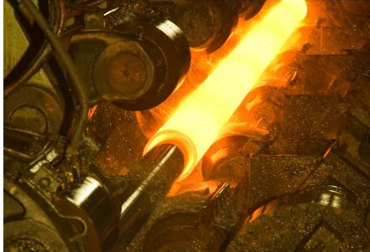
Figura 16 – Injeção de matriz rígida no tarugo de aço aquecido formando a geometria circular dos tubos (V&M, 2008).
