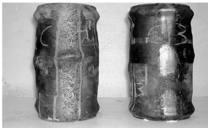
Figura 45 – Modo de falha típico dos corpos-de-prova (GIAKOUMELIS e LAM, 2004).
