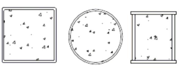
Figura 29 – Seções típicas de pilares mistos preenchidos (FIGUEIREDO, 1998).
