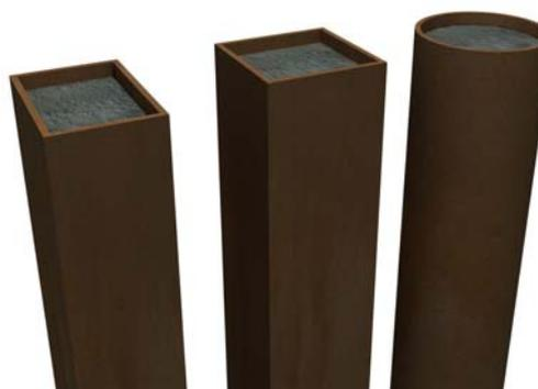
Figura 51 – Modelos de pilares mistos com a formação da pátina interna.
