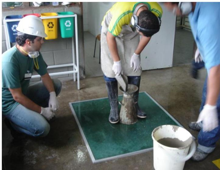
Figura 56 – Ensaio de espalhamento no cone de Abrams para verificação de *Slump Test* e *Flow Test* do concreto auto-adensável.
