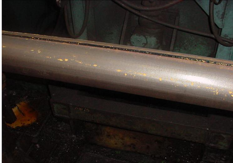
Figura 24 – Eletrofusão para a união das extremidades (USIMINAS, 2008).
