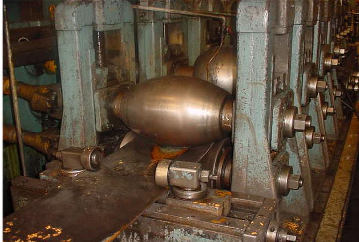
Figura 22 – Conformação a frio das bobinas de aço (USIMINAS, 2008).
