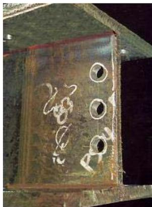
Figura 4 – Aspecto dos perfis soldados à arco submerso (USIMINAS, 2008).
