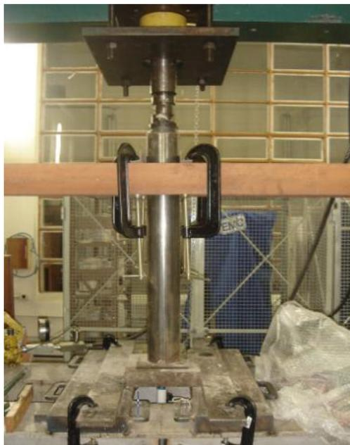
Figura 69 – Madeira e cantoneiras utilizadas para evitar o tombamento do CP durante os ensaios.
