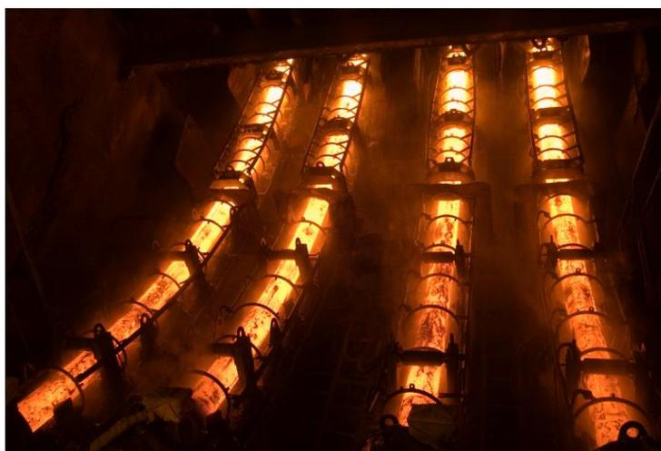
Figura 15 – Processo de lingotamento contínuo (V&M, 2008).
