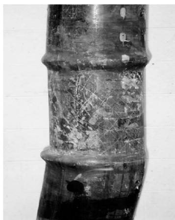
Figura 47 – Falha da coluna (ELREMAILY e AZIZINAMINI, 2002).
