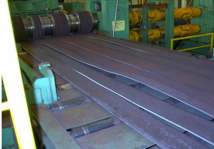
Figura 20 – Corte da bobina em tiras pela *Sliter* (USIMINAS, 2008).
