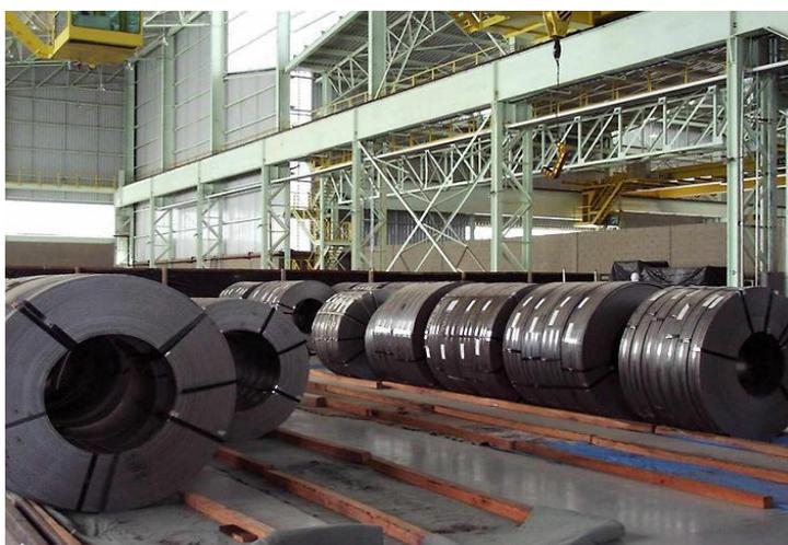
Figura 19 – Estoque de bobinas laminadas à quente (USIMINAS, 2008).
