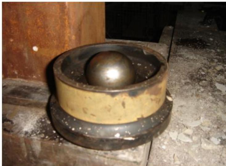
Figura 61 – Rótula utilizada na extremidade do atuador hidráulico.
