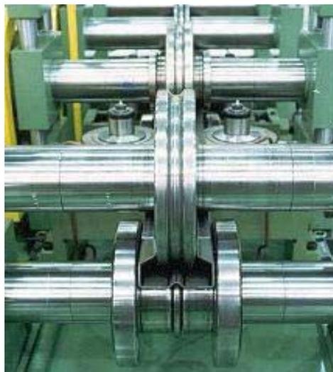
Figura 11 – Processo de perfilação a frio de chapas (USIMINAS, 2008).
