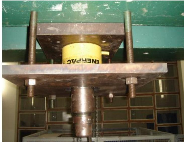
Figura 60 – Atuador hidráulico utilizado nos ensaios.
