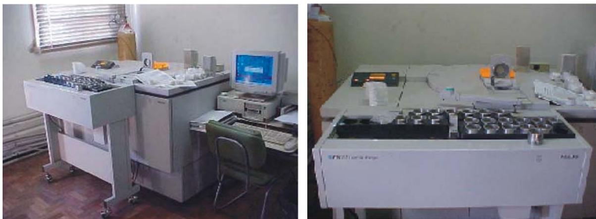
**FIGURA 3-30 – Aparelho para realização da espectrometria de fluorescência de raios-X (FRX).**
