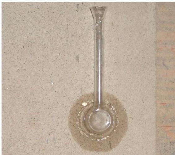
FIGURA 4-34 – Execução de ensaio de permeabilidade à água
