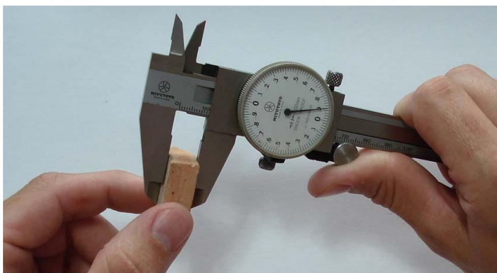
**FIGURA 4-42 – Medição da espessura de camada retirada por lixamento da amostra**
