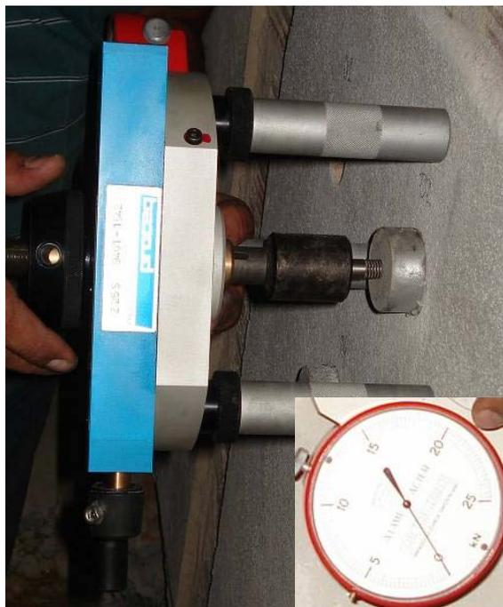
**FIGURA 4-33 – Execução de teste de aderência**
