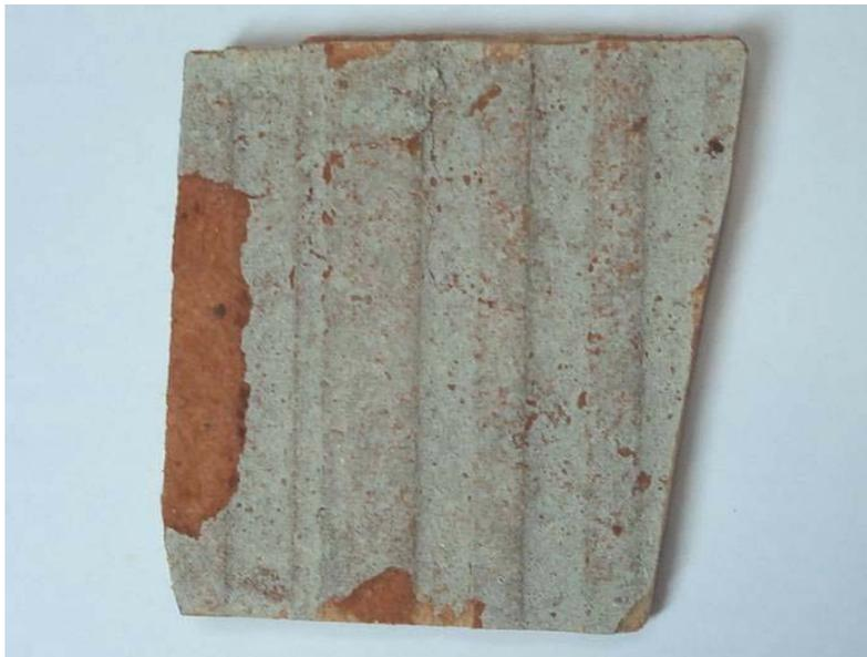
FIGURA 5-51 – Interface do tijolo após de destacamento da argamassa.
