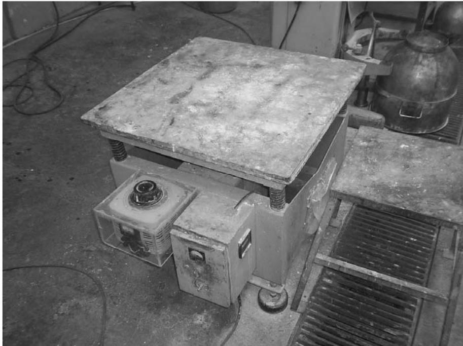
**Figura 4.1.2:** Mesa vibratória com intens. variável para moldagem de cp's.
