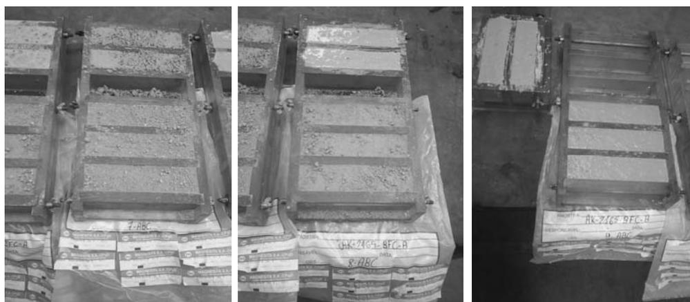
**Figura 4.1.6:** Cura dos cp's: 7A, 7B, 7C, 7D e 7E (esquerda); 8A, 8B, 8C, 8D e 8E (centro); 9A, 9B e 9C (direita).
