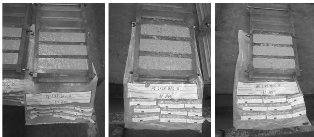
**Figura 4.1.7:** Cura dos cp's: 10A, 10B e 10C (esquerda); 11A, 11B e 11C (centro); 12A, 12B e 12C (direita).
