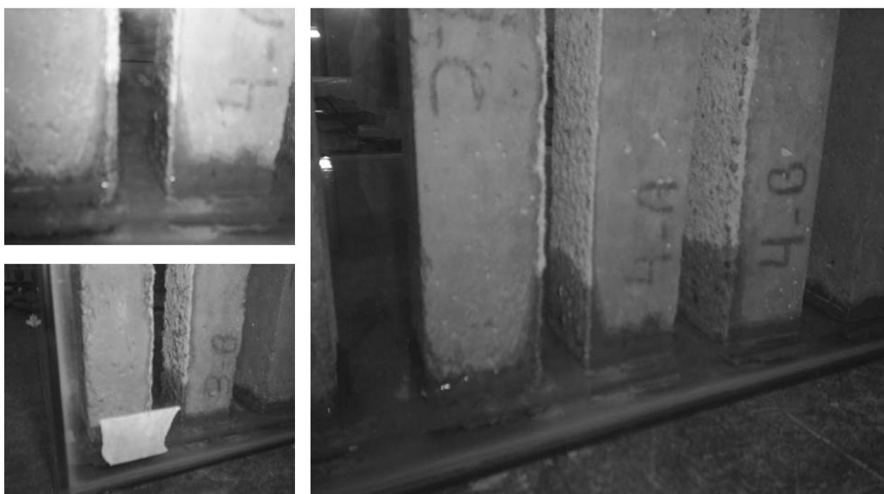
**Figura 5.3.5: Propagação capilar nas superfícies não conformadas (I).**
