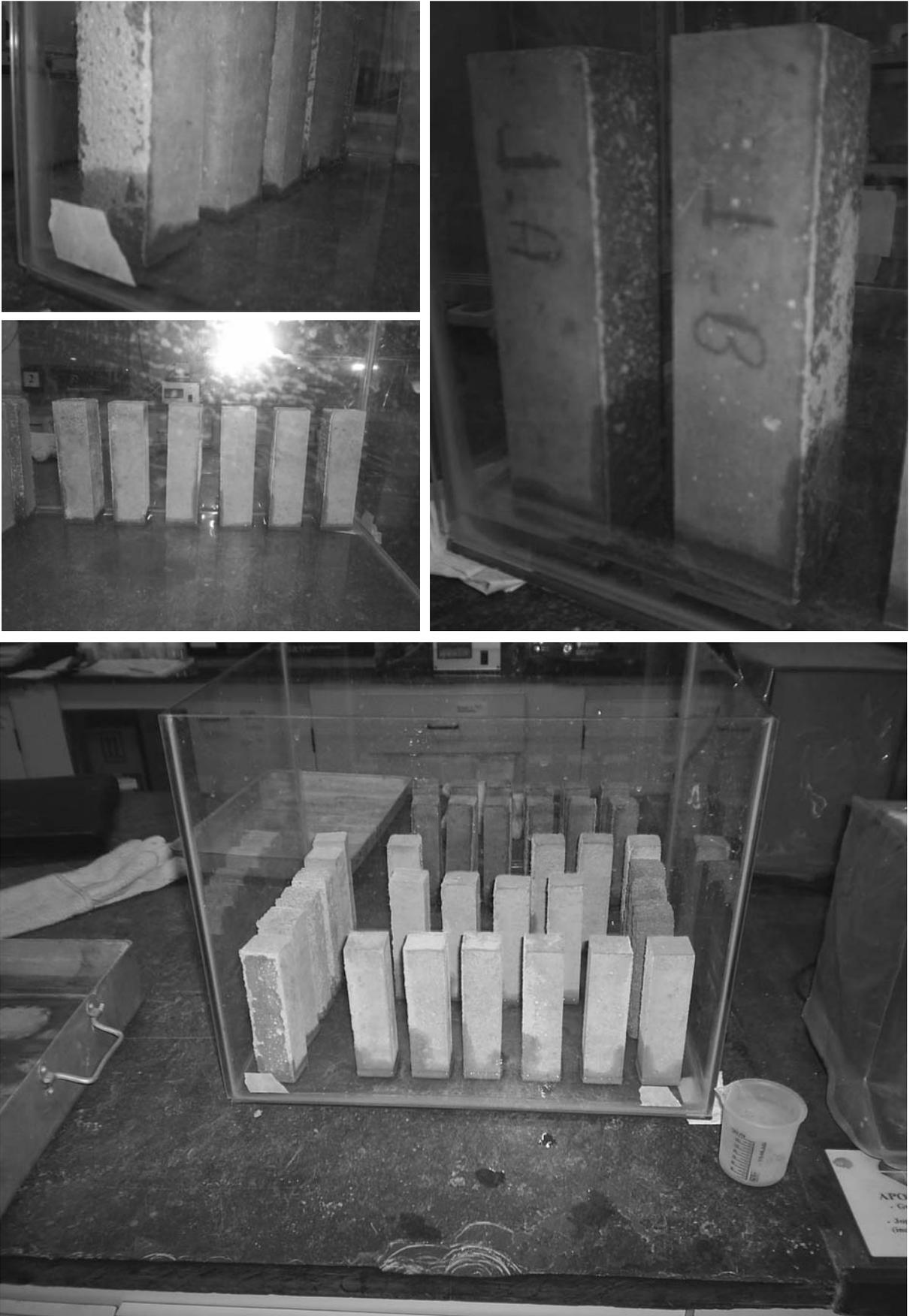
**Figura 5.3.7: Propagação capilar nas superfícies não conformadas (III).**
