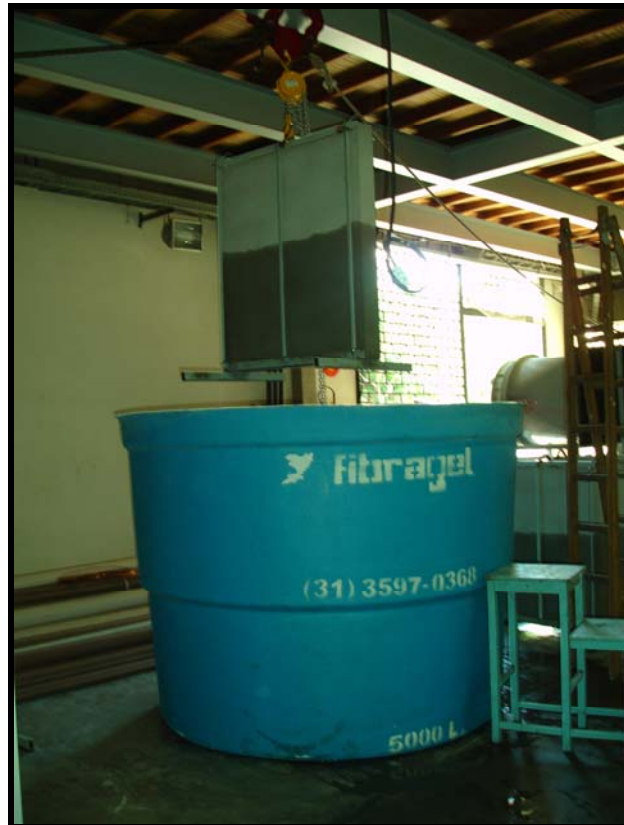
Figura 4.31. – Vista de outro painel sendo retirado após (02) horas de imersão.
