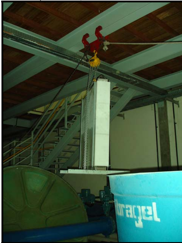
Figura 4.30. – Vista de um painel em deslocamento horizontal sendo retirado do reservatório após duas (02) horas de imersão.
