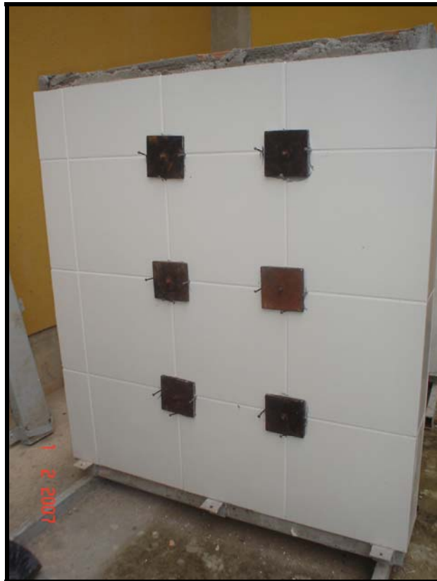
Figura 4.20. – Vista de placas quadradas coladas.
