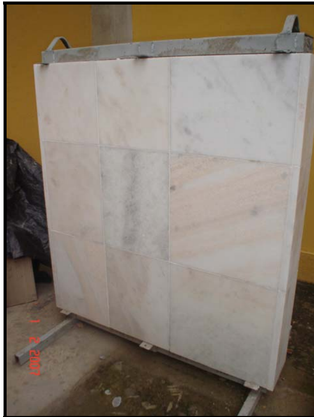
Figura 4.14. – Vista de painel revestido com placas de mármore branco e rejuntado.
