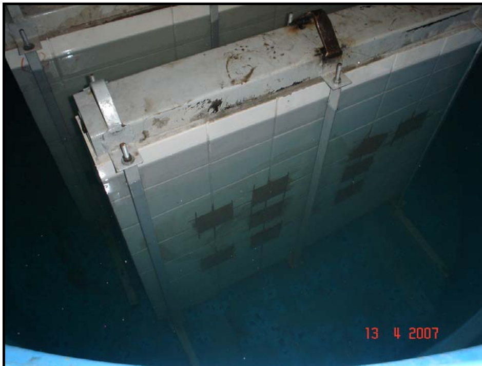
Figura 4.35. – Vista de dois painéis imersos no reservatório – Profundidade de imersão dos painéis = 1,10m.
