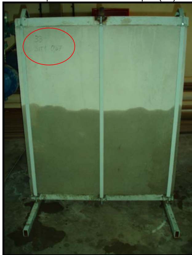
Figura 4.32. – Vista de painel após ser retirado– Altura molhada do painel = 0,67m.
