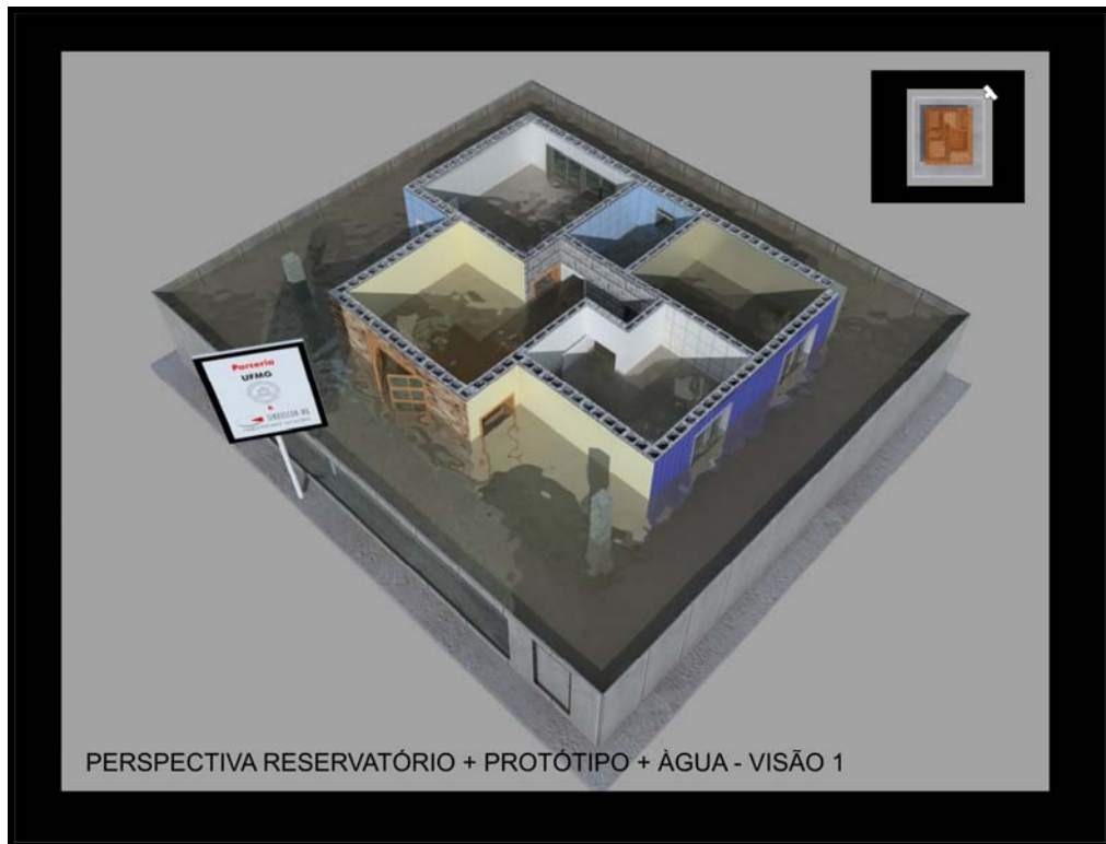
Figura 8.3. – Outra perspectiva da casa inserida no reservatório contendo água de inundação (sem cobertura).
