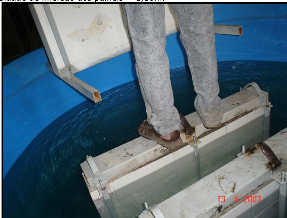
Figura 4.36. – Vista de terceiro painel sendo imerso no reservatório – Profundidade de imersão dos painéis = 1,10m.
