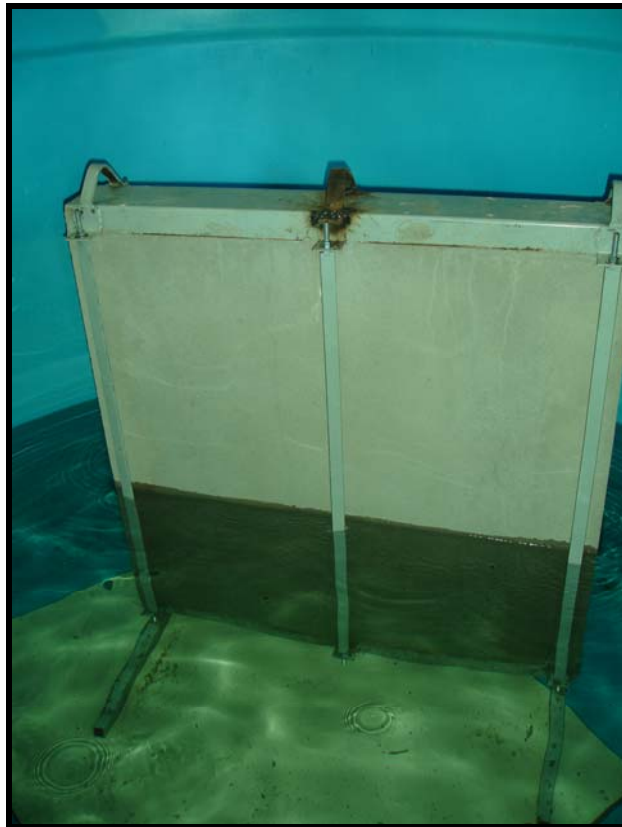
Figura 4.27. – Vista de painel imerso no reservatório – Profundidade de imersão do painel = 0,50m.
