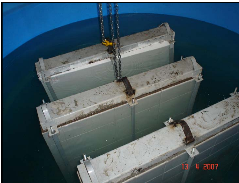
Figura 4.37. – Vista de três painéis imersos no reservatório – Profundidade de imersão dos painéis = 1,10m.
