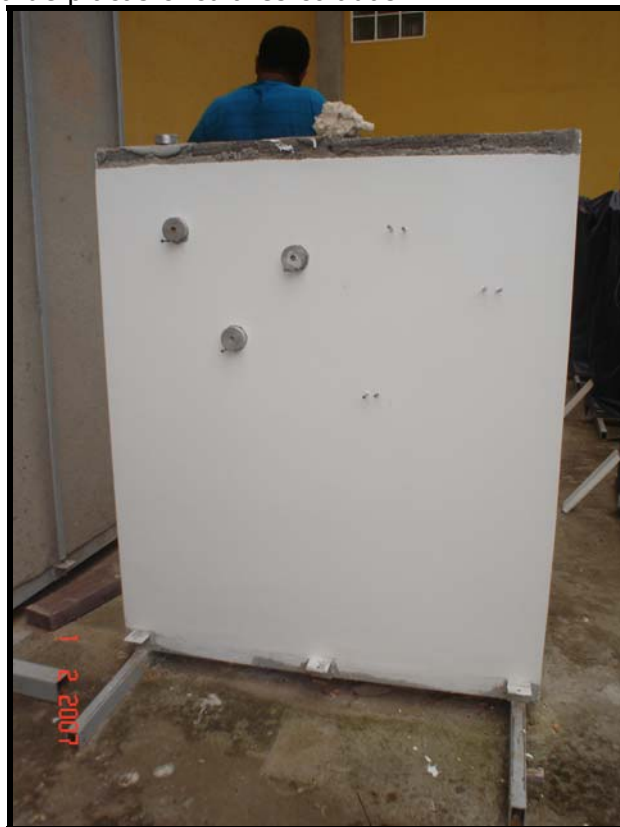
Figura 4.19. – Vista de placas circulares em fase de colagem (sem cortes prévios).
