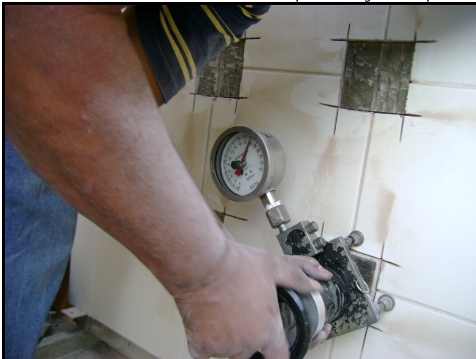
Figura 4.23. – Vista de um painel com revestimento cerâmico –arrancamento dos corpos de prova.
