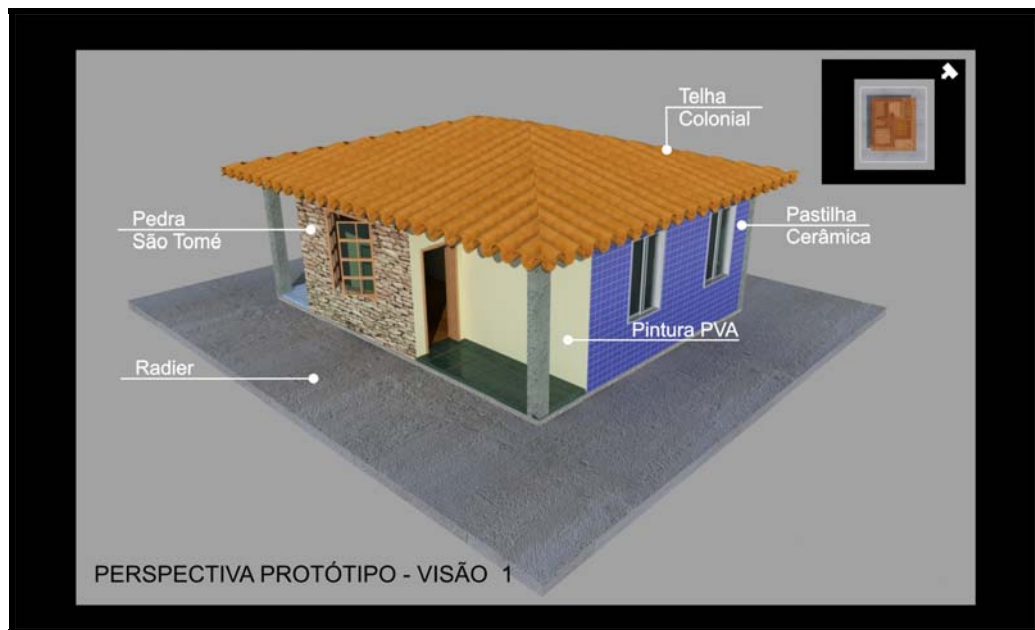
Figura 8.1. – Perspectiva da casa indicando diversas tipologias de revestimento.
