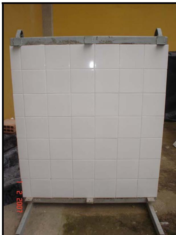
Figura 4.10. – Vista de painel azulejado e rejuntado.
