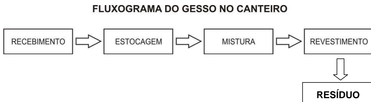
Figura 2.11– Fluxograma do gesso no canteiro (adaptado de ALVES et al. , 2006).
