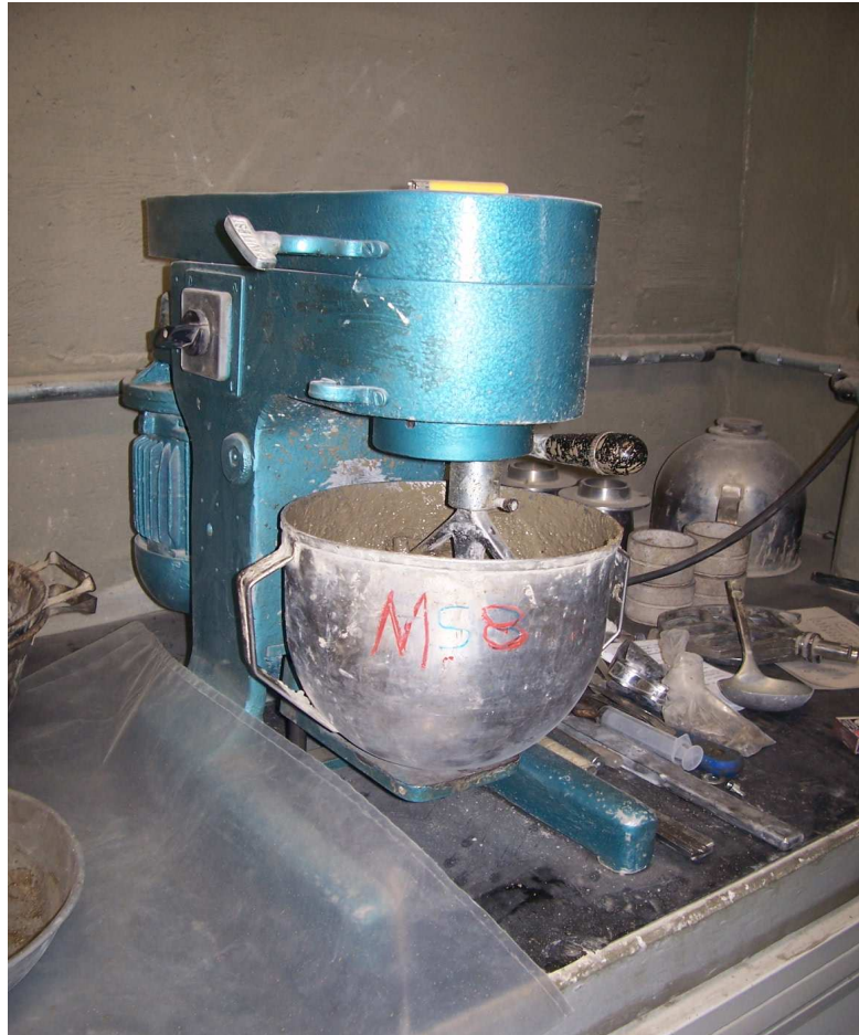
Figura 3.2– Foto do misturador mecânico utilizado na confecção dos corpos de prova.
