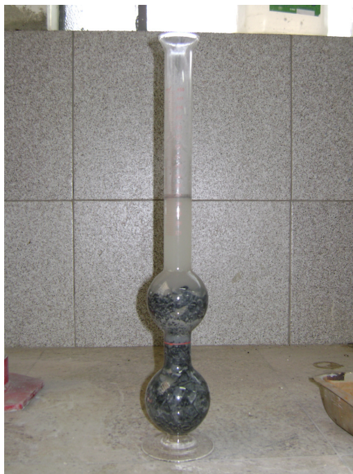
Figura 3.4 - Ensaio de massa específica do calcário da região de Belo Horizonte
