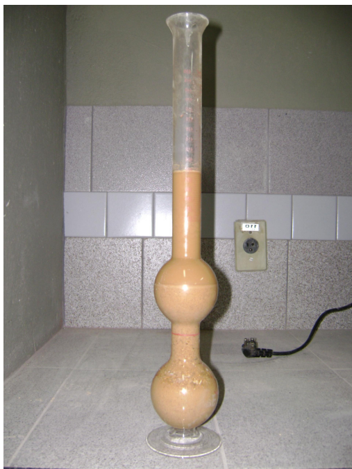
Figura 3.1 - Ensaio de massa específica da areia
