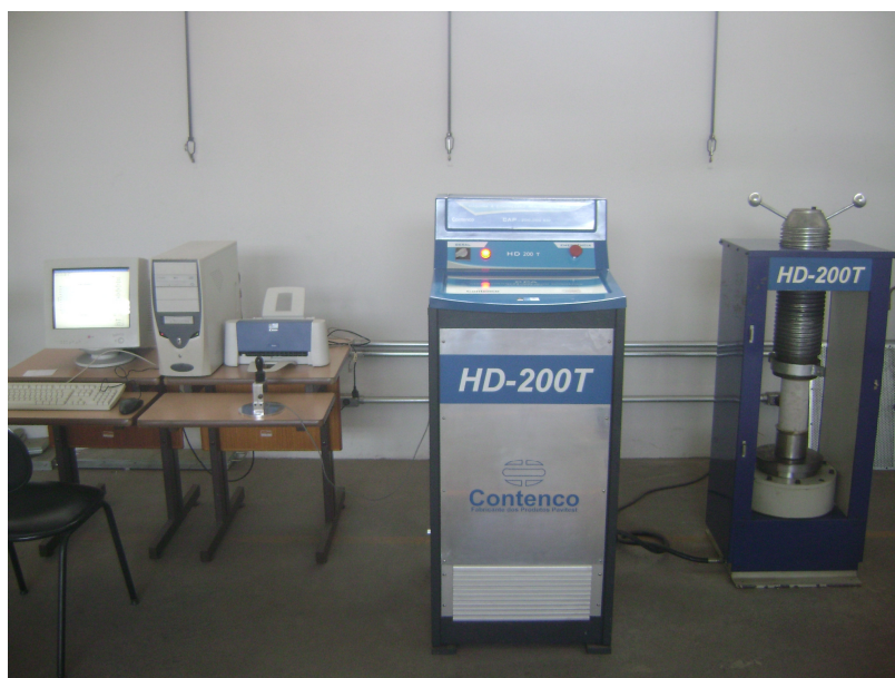
Figura 3.12 – Equipamentos utilizados nos ensaios do concreto endurecido
