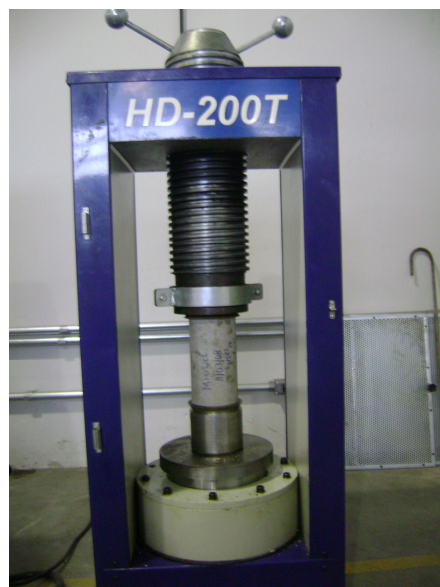
Figura 3.11 – Prensa utilizada nos ensaios do concreto endurecido
