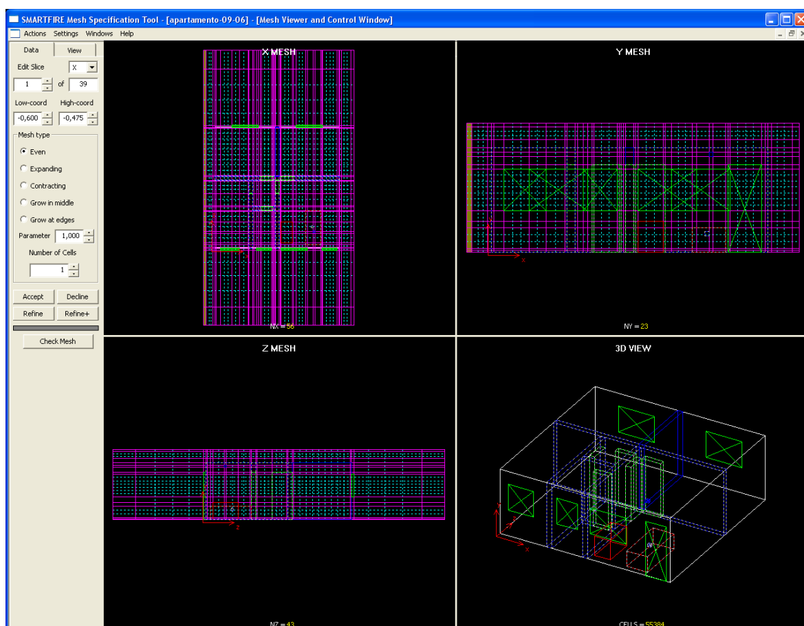
FIGURA 9.7: Malha de elementos finitos
