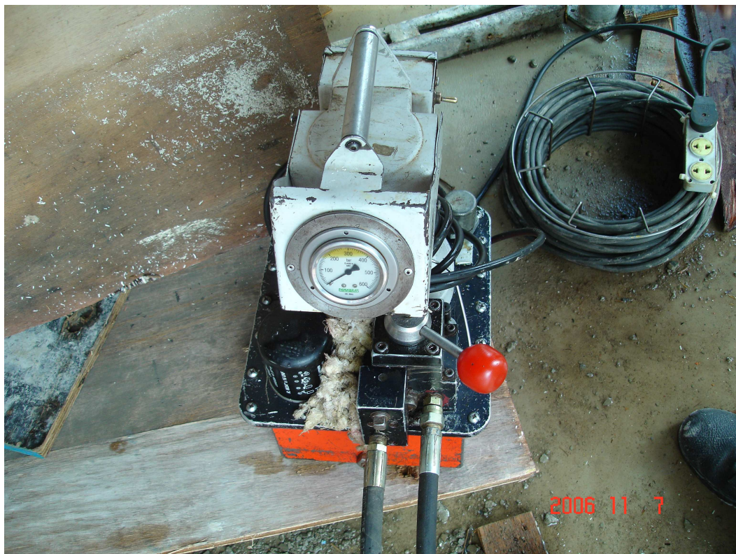
Figura 2.10 – Detalhe da bomba hidráulica para protensão
