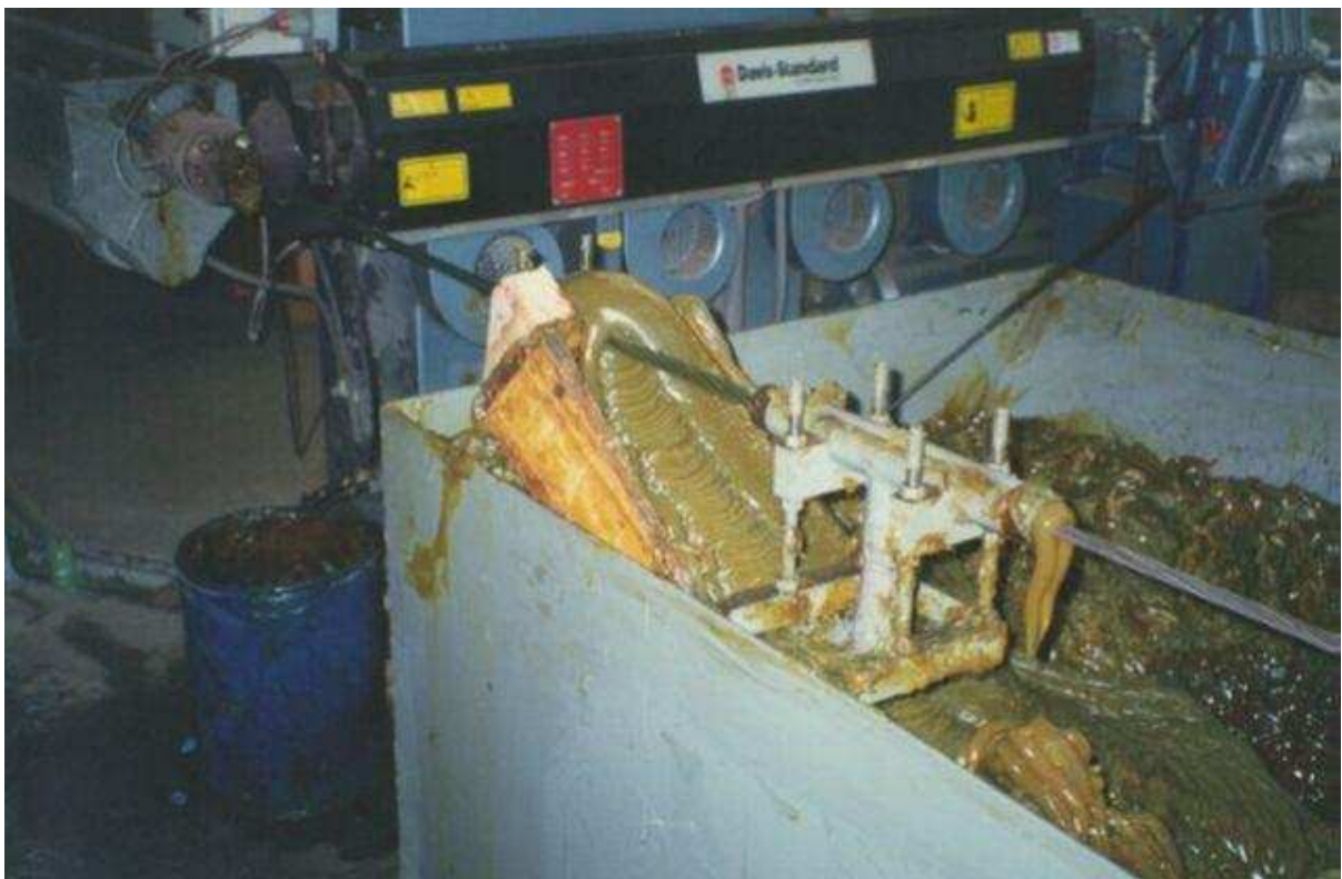
Figura 2.1 – Engraxamento do cabo (BELGO BEKAERT ARAMES)
